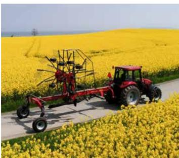
Die Vicon Mittelschwader lassen sich für den Transport bequem vom Schleppersitz aus hydraulisch in Transportposition bringen.
