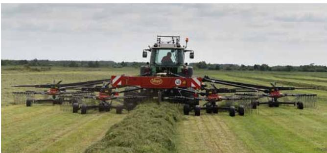
Die Arbeitsbreite und die Schwadbreite werden hydraulisch eingestellt. Die Arbeitsbreite ist von 10,00 – 12,50 m wählbar und die Schwadbreite von 1,20 – 2,20 m.
