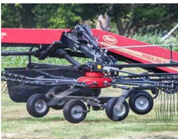
Bodenschonend und hervorragende Grundfutterqualität dank TerraLink Plus. Die Aushubhöhe am Vorgewende beträgt ca. 50 cm. Dies verhindert dass volumige Schwaden am Vorgewende auseinander gezogen werden.
