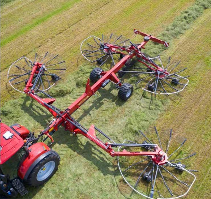
Die einzigartige Ellenbogenkonstruktion der vorderen Kreisel ermöglicht dem Fahrer einen sehr guten Überblick über die gesamte Arbeitsbreite und die hinteren Kreisel der Maschine.
