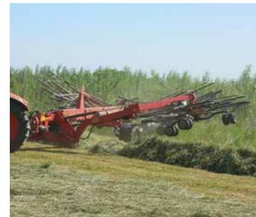
Die maximale Aushubhöhe am Vorgewende ist beachtlich. Bei Bedarf kann sie am Vorgewende individuell eingestellt werden.
