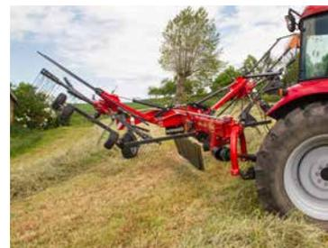
80° Einschlagwinkel dank aktiv gesteuertem Fahrwerk.
