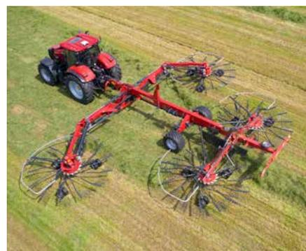
Die Arbeitsbreite ist hydraulisch von 9,80 bis 15,00 m über das Bedienterminal einstellbar.
