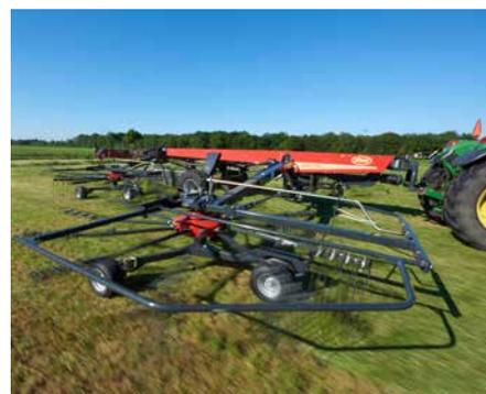
Das TerraLink Quattro System bietet die perfekte Boden Anpassung der Kreisel in alle Richtungen. Dies wird durch einen flexiblen Träger zwischen Mittelrahmen und dem Rotor in Verbindung mit dem Quattro-Konturfahrwerk gewährleistet.
