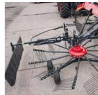
Automatisches Klappen des Schwadtuches.
