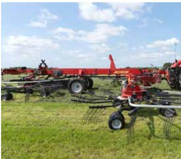
Die Arbeitshöhe eines jeden Rotors kann individuell eingestellt werden.
