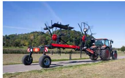
Transporthöhe unter 4 m mit aufgesteckten Zinkenarmen.
