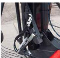
Hydraulische Transportverriegelung (optional).
