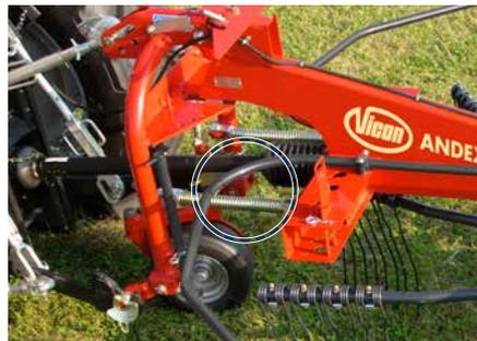
Schwingungsdämpfer für ein exzellentes Nachlaufverhalten.
