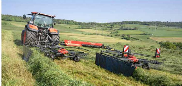
Der Andex 715T Vario mit 7,10 m Arbeitsbreite und dem patentierten SideShift.
