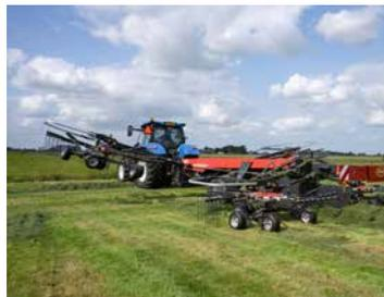
Für den Andex 1304 Pro ist eine elektrische Höhenverstellung erhältlich. Der Fahrer kann für jeden Kreisel individuell einen Nullpunkt für die Rechhöhe festlegen. Die Absenkung über diesen Punkt wird
