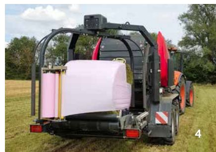
A csomagolóasztal gyorsan elmozdul a fóliakifeszítők irányába és a csomagolás azonnal kezdődik.
