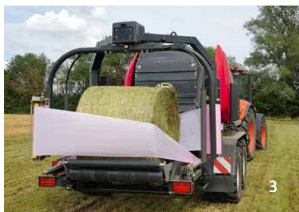
Amint a bála továbbbútorodik a bálázótól, a bálakigurító azonnal becsukódik és a bálázási művelet újraindul.
