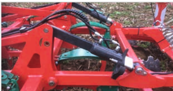
Zadní válec Endura není zavěšen pomocí paralelogramu, nastavuje se hydraulicky za pomoci distančních podložek.
