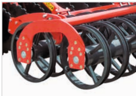
Actipress Twin ø 560 mm – 220 kg/m (nedostupné u sklopných modelů Enduro/Enduro Pro)
