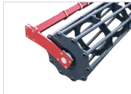
Klecový válec ø 550 mm – 90 kg/m
