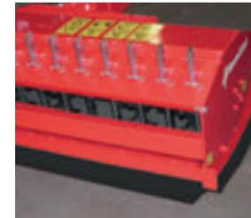
FHS от Kverneland может быть оснащен грабельными зубьями для улучшения качества измельчения на обрезках.
