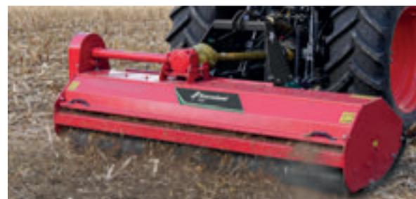
Для обеспечения постоянного контроля рабочей высоты FXE может быть дополнительно оснащен задним роликом (диаметром 195 мм) или двумя оборотными колесами (155 SR13).
