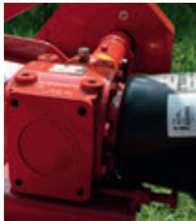
Все редукторы в линейке мульчировщиков Kverneland в стандартной комплектации оснащены встроенной обгонной муфтой.
