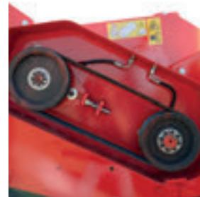
Модель FXZ во всех вариантах оснащена двойной боковой трансмиссией. Внешние и централизованные точки смазки ротора обеспечивают более быстрое обслуживание.
