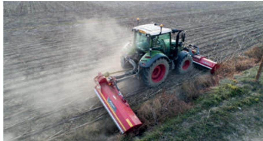
Надежный и защищенный. Сочленения главной рамы и параллелограмма разработаны в соответствии с анализом и расчетами FEM, а также тщательно испытаны в лаборатории Kverneland Klepp для обеспечения надежного и длительного срока службы. Редуктор и трансмиссия защищены от неправильного использования во время работы.
