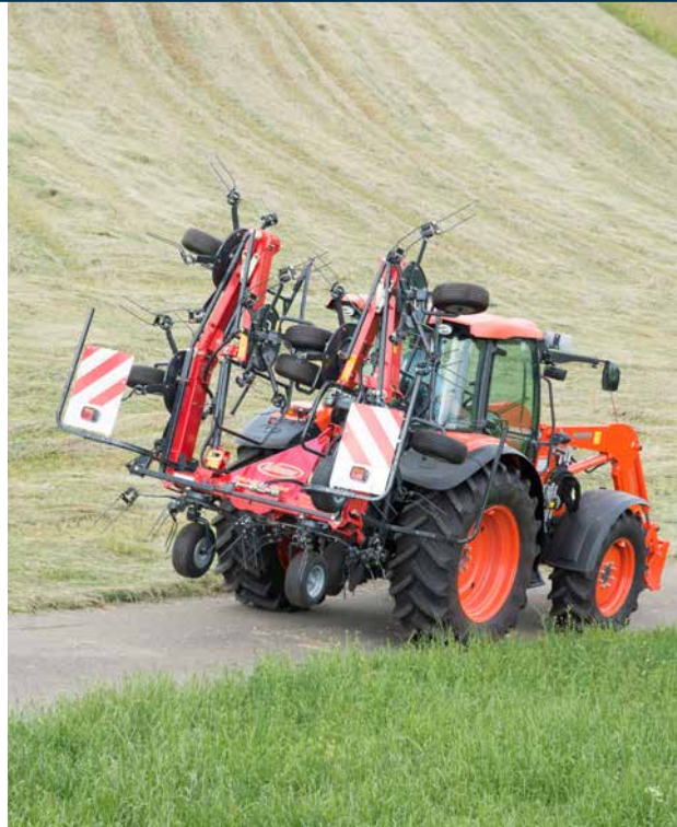
A Fanex 804 nagyon kompakt helyzetbe csukható szállításhoz.
