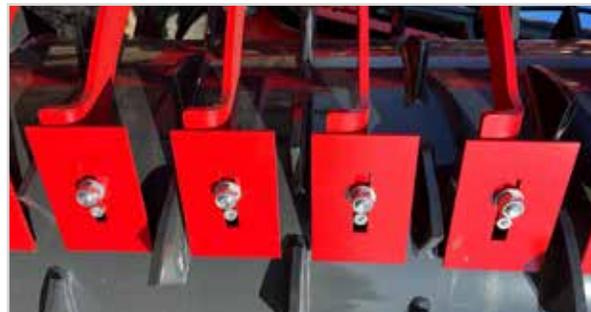
Die Actiline- und Zahnpackerwalzen können mit Standard- oder Hartmetallabstreifern ausgestattet werden, um ein Blockieren durch klebrige Böden zu verhindern.
