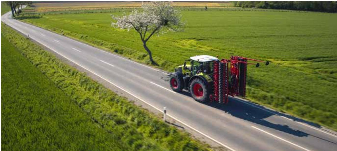
Schnell vom Feld auf die Straße und umgekehrt. Einfache Klappung von Arbeits- und Transportposition von der Traktorkabine aus.
