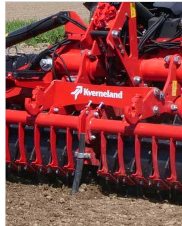
Ein Gummidammstriegel sorgt für eine gleichmäßige Nivellierung auch zwischen den Walzensegmenten.
