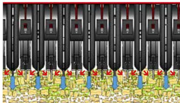
Die Konstruktion der Ringe und die speziellen Flankenwinkel der Actipackwalze ermöglichen eine optimale Rückverfestigung in der Tiefe, ohne die Bodenaggregate der oberen Bodenschicht zu verdichten. Zudem bietet das Profil eine gute Wetterfestigkeit und Feuchtigkeitstransfer.
