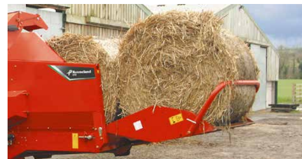
Składany pałąk asekurujący belę podczas przemieszczania się z miejsca ich składowania do budynków inwentarskich.
