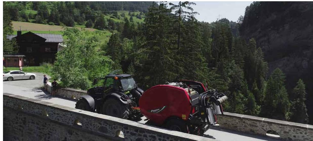
Le système d'enrubannage innove en matière de compacité. Pendant le transport, le rouleau arrière et les satellites sont repliés en position verticale, ce qui réduit considérablement la longueur totale, tandis que tous les éléments d'enrubannage sont à l'abri de
