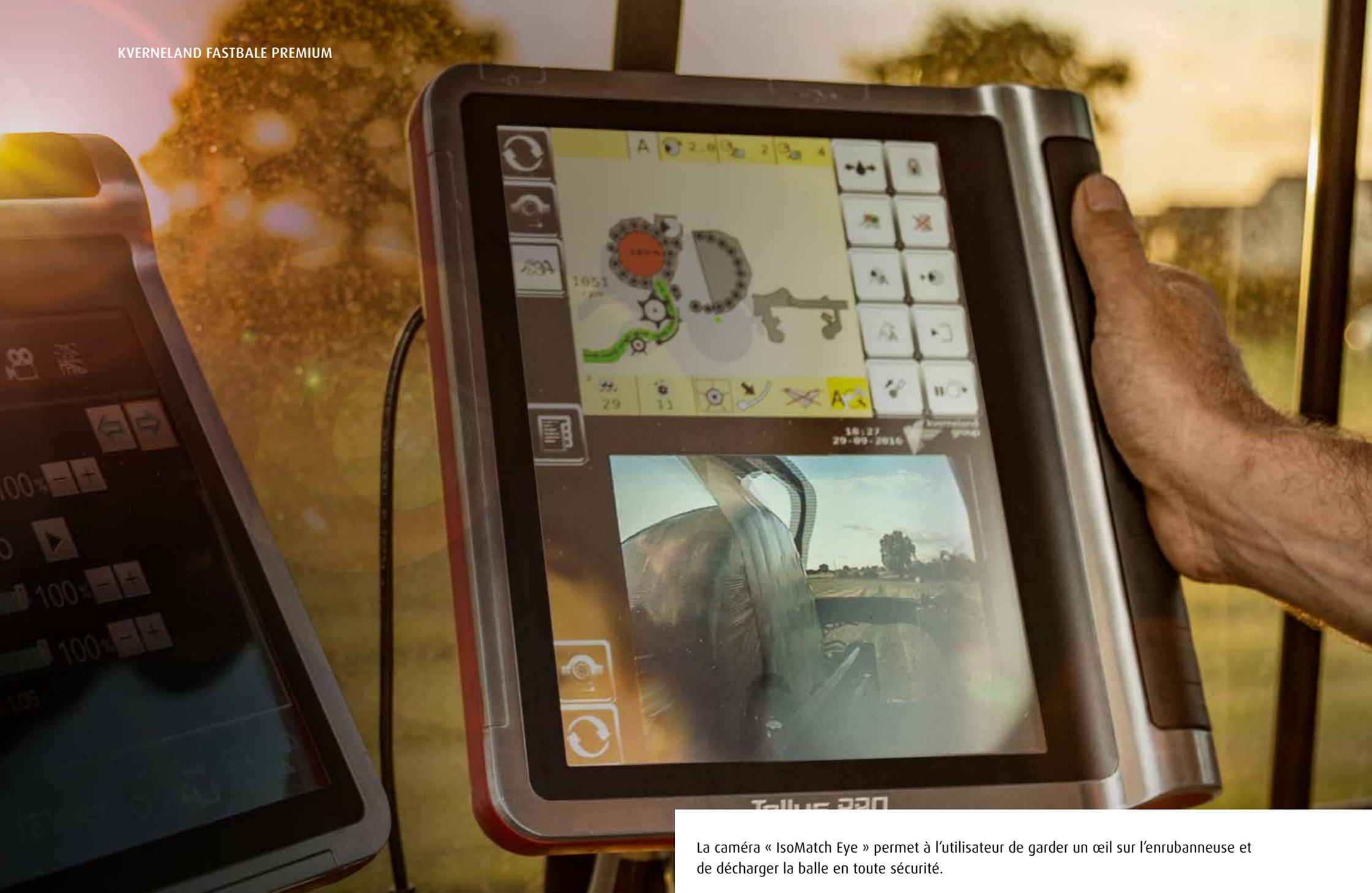
La caméra « IsoMatch Eye » permet à l'utilisateur de garder un œil sur l'enrubanneuse et de décharger la balle en toute sécurité.
