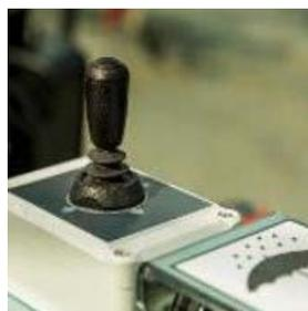
Tutti i modelli con computer sono dotati di un joystick elettronico compatto che può essere montato sul trattore, consentendo l'avvio utilizzando un solo dito per le funzioni di avvolgimento e di ribaltamento delle balle, nonché l'immediata esclusione manuale di altre funzioni in qualsiasi momento.
