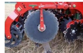
I dischi laterali mantengono la terra sciolta nella banda e definiscono la larghezza e la forma della banda.
