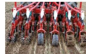
Le ruote di pressatura riconsolidano il terreno. Tre diverse ruote di pressatura offrono la massima versatilità in caso di condizioni del terreno variabili.
