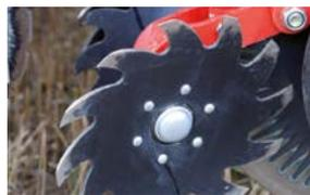
Le ruote spostaresiduo rimuovono un'elevata quantità di residui dalla banda per ottenere un letto di semina pulito.
