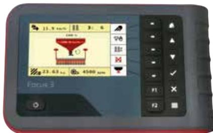
Терминал Focus 3 управляет системой e-bas для контроля всех основных электронных функций машин, таких как дозатор ELDOS, датчик низкого уровня загрузки бункера и различные системы закладки тех.колеи. Focus 3 не совместим с ISOBUS и не поддерживает сигналы и приложения GPS.
