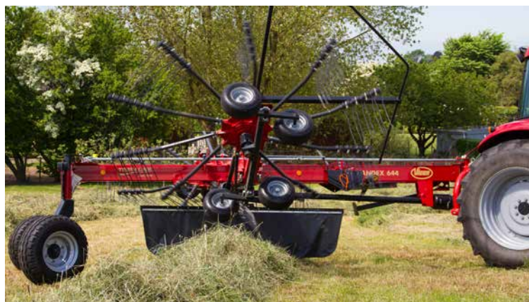
De hoogte van het frame biedt uitstekende bodemvrijheid op kopakkers.
