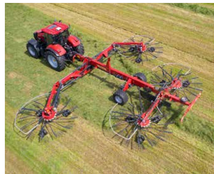
De twee voorste rotoren kunnen individueel ingesteld worden tussen een werkbreedte van 9.8m en 15.0m.
