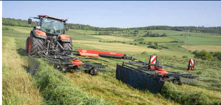
De 715T Vario met 7.10m werkbreedte en unieke SideShift inrichting.
