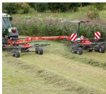
Beide rotoren kunnen kleine zwaden maken voor hooibouw.
