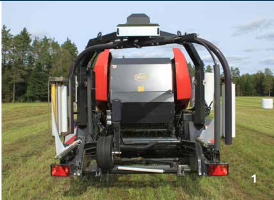
1 Aussitôt le filet appliqué à la balle, la table d'enrubannage s'avance sous la porte de la presse.
