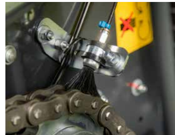
La lubrification automatique des chaînes est incluse en standard.
