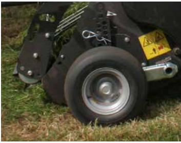
Roues de jauge avec réglage simple de la hauteur de ramassage.
