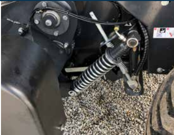
Relevage hydraulique du pick-up avec système de suspension intégré pour un suivi précis du terrain.
