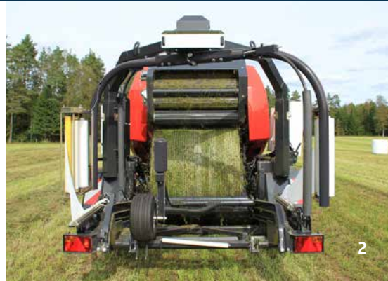
2 La balle est réceptionnée directement sur la table d'enrubannage.
