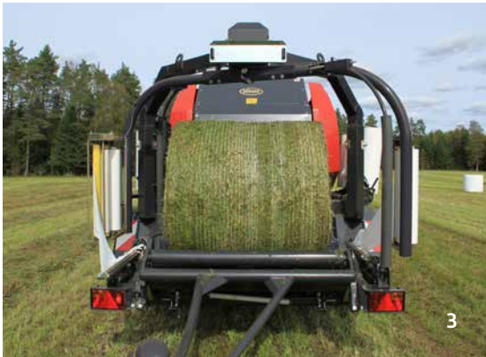
3 Aussitôt la balle sortie de la presse, la porte se referme automatiquement et le pressage peut reprendre.
