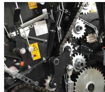
Des chaînes 1¼” de type HBC sont utilisées pour l'entraînement de la chambre de pressage et du rotor.
