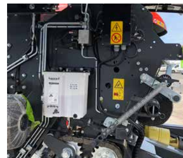
Tuyaux rigides en acier pour le circuit hydraulique.
