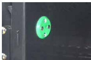
Capteurs d'humidité situés à l'intérieur de la chambre de pressage.
