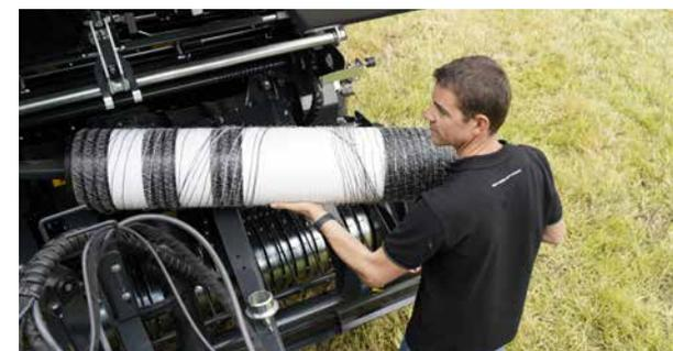
La baja altura de carga y el muy fácil enhebrado del sistema significan un tiempo de inactividad mínimo y un tiempo máximo de empacado.
