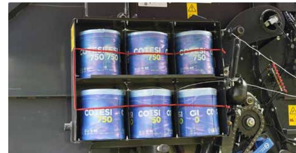
Almacenamiento para hasta seis bobinas de hilo.
