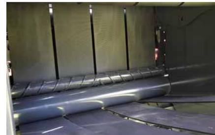
Rodillo rascador de perfil en espiral para una limpieza eficaz en cualquier condición.
