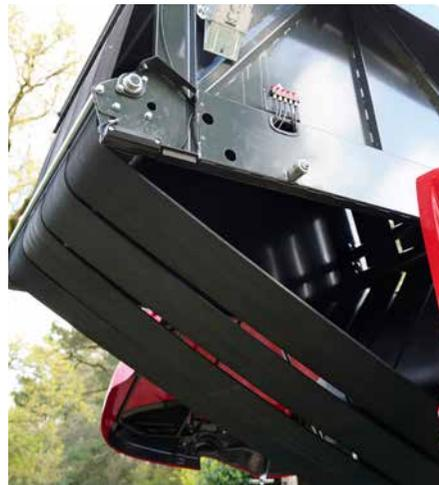
Los modelos Kverneland Densus 7060 y 7090 están equipados con cuatro correas sin fin duraderas que ofrecen un funcionamiento suave y un bajo mantenimiento.
