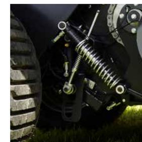
Pick-up con sistema de suspensión integrado para un seguimiento preciso del terreno.
