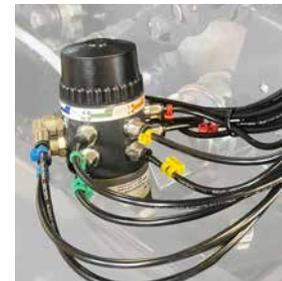
Lubricación automática de la cadena con salidas ajustables individualmente.
