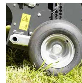
Grandes neumáticos flotantes con ajuste de altura integrado.
