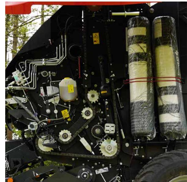
El almacenamiento vertical del rollo de red permite un fácil acceso a la transmisión de la empacadora.
