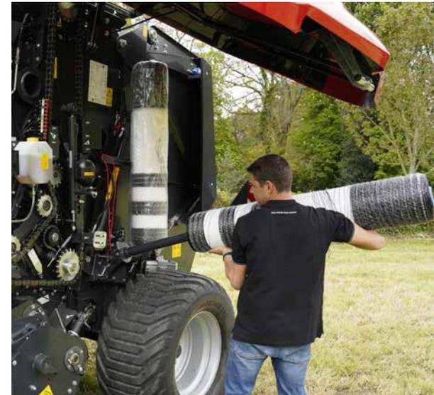
El almacenamiento inteligente en vertical de los rollos de red permite una cómoda carga horizontal en el atador.
