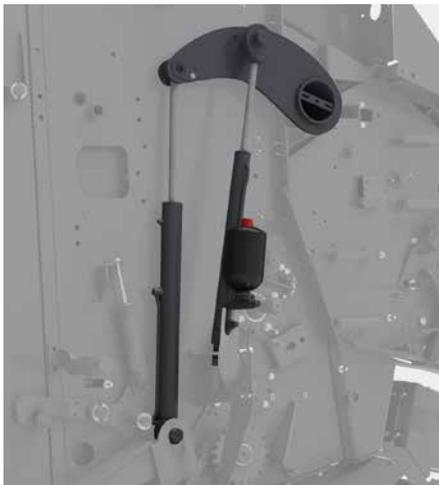
El tensor de las correas de carga hidráulica permite un cierre rápido del portón trasero para un alto rendimiento.
