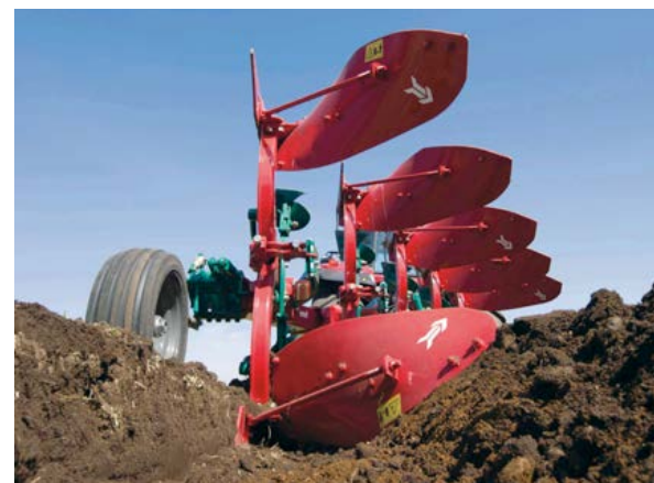
Profil brázdy orebního tělesa č. 28 Pracovní hloubka: 26 cm, dno: 30 cm, šířka: 73 cm
