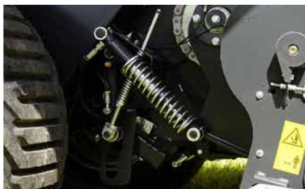
Relevage hydraulique du pick-up avec système de suspension intégré pour un suivi précis du sol.
