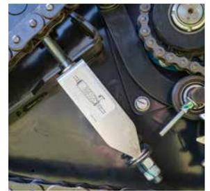
La tension des chaînes est facile à contrôler grâce aux repaires visuels.
