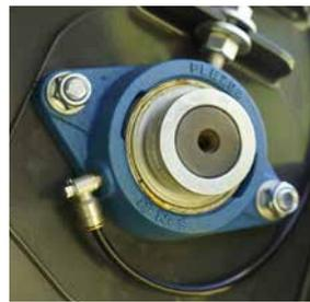
Les roulements externes réduisent le temps de maintenance.
