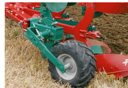
Koło kopijąco-transportowe montowane z tyłu pługa z hydrauliczną regulacją głębokości
