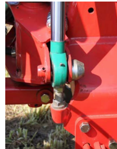
Regulacja kąta pługa dla lewej i prawej strony
