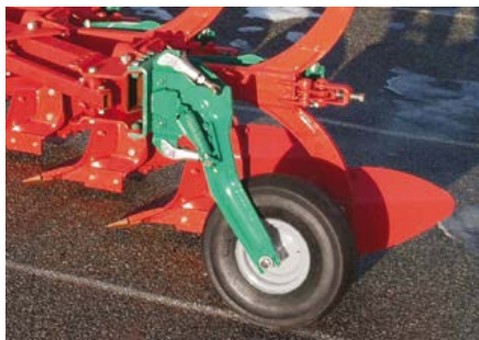
Koło kopiujące montowane z tyłu pługa z amortyzatorem
