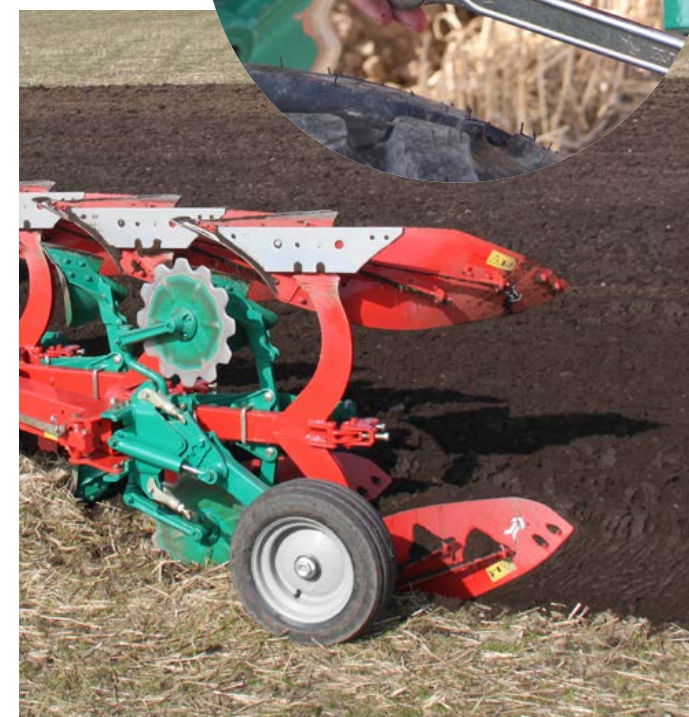
Łatwe i szybkie ustawianie głębokości orki za pomocą śruby w kształcie litery Y
