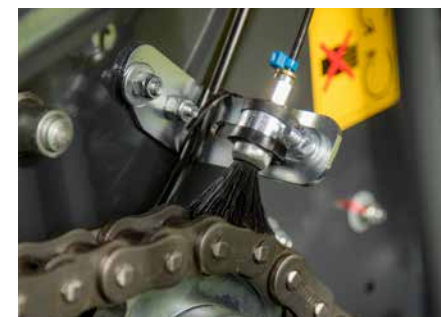
Automatyczne smarowanie łańcucha jest standardem w Kverneland 6500F.
