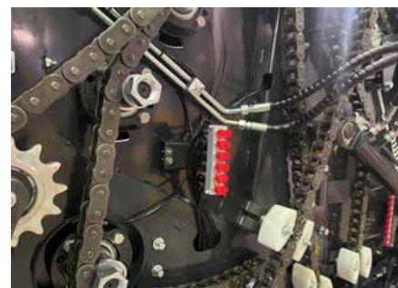
Zcentralizowane kalamitki do łożysk rolkowych komory prasowania.
