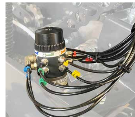
Automatyczne smarowanie łańcucha z indywidualnie regulowanymi wylotami.
