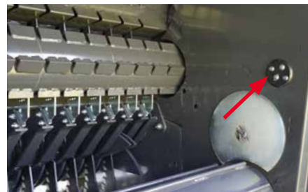
Sensore di umidità situato all'interno della camera di pressatura.
