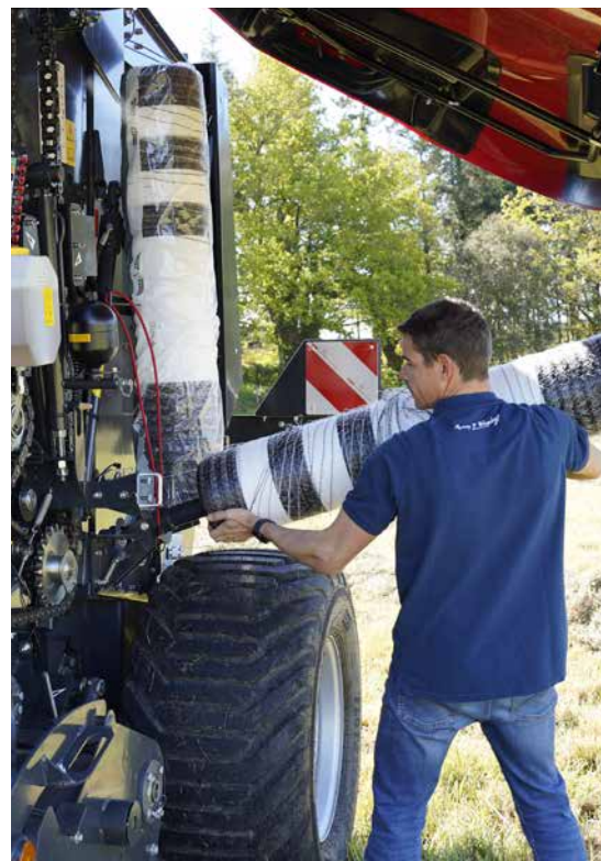
Il pratico sistema di stoccaggio della rete consente un comodo caricamento orizzontale.
