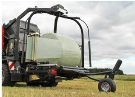
Enrubanneuse double satellite munie de 2 pré-étireurs et de 4 courroies sans fin pour un enrubannage rapide et régulier.
