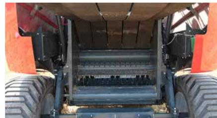
Un ensemble de cinq courroies et trois rouleaux permettent d'obtenir **des balles denses avec un cœur tendre et un démarrage de balle facile**.
