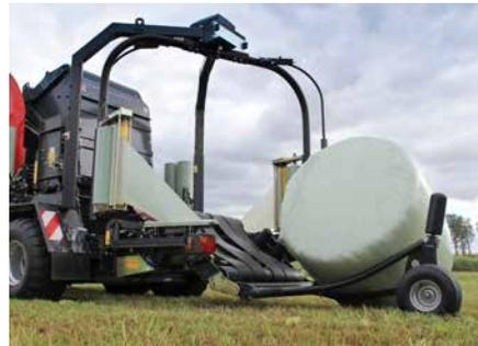
Pendant le transport, le vire balle est automatiquement positionné en sécurité sur l'enrubanneuse.
