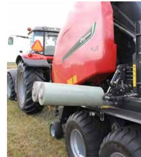
Stockage de 10 rouleaux de film de rechange abaissé hydrauliquement.
