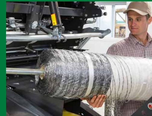
La hauteur de chargement très basse et le système très simple de liage permettent des temps d'arrêt plus courts et laissent plus de temps à la formation de balle.
