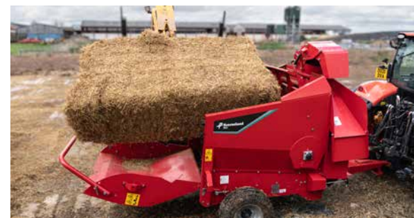
Széles hozzáférés a bálák oldalról történő betöltéséhez.
