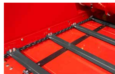
Az 'UltraGlide' műanyag kopó betétek minimumra csökkentik a lánc kopását.
