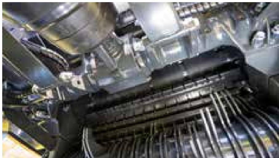
Integriertes einteiliges Hauptgetriebe
