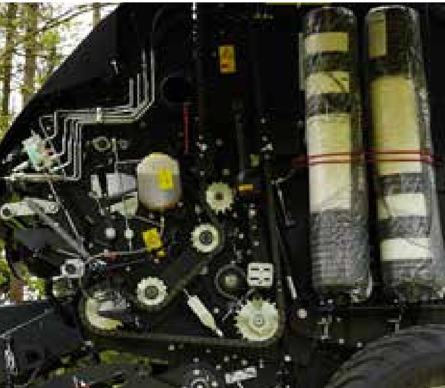
Die vertikale Netzrollenlagerung ermöglicht einfachen Zugang zum Antrieb der Presse.
