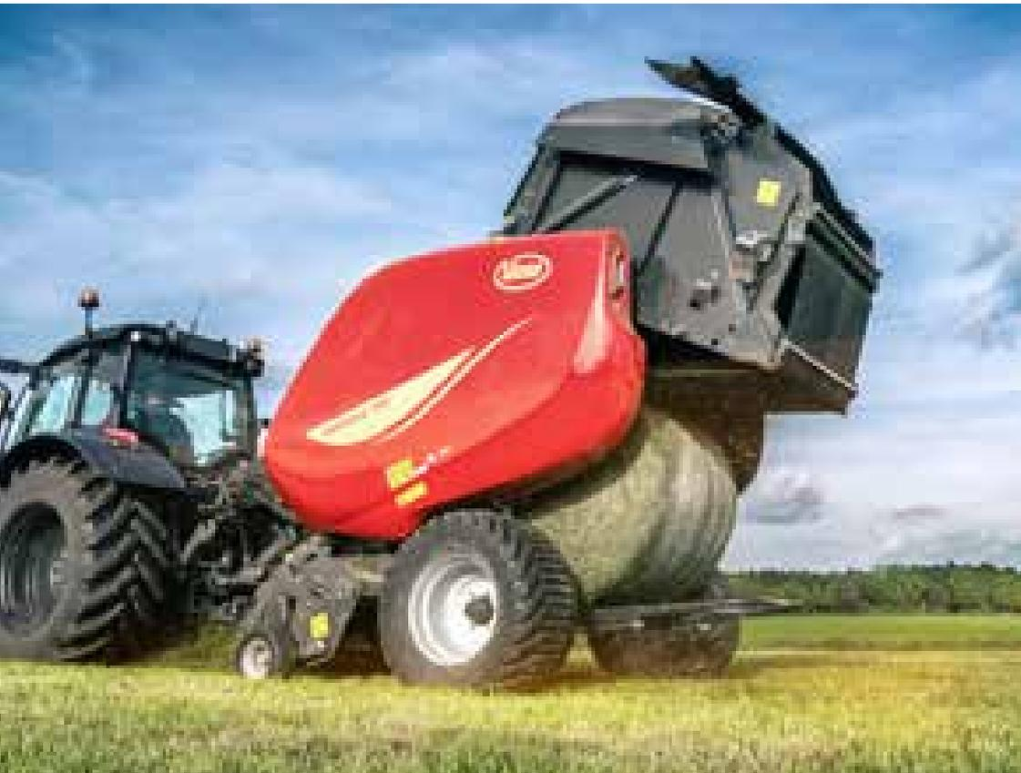
Hydraulischer Bandspanner und schnelle Heckklappenöffnung machen die VariBale Serie zu einer der effizientesten Rundballenpressen am Markt.
