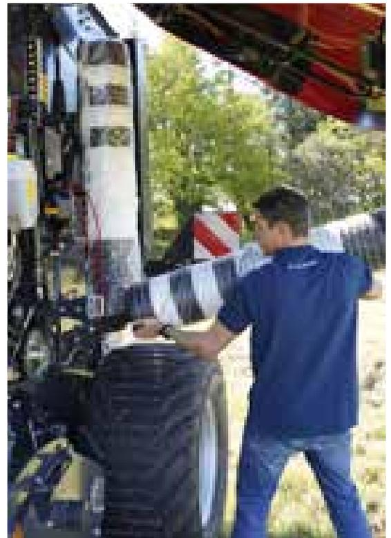
Die clevere Netzrollenlagerung ermöglicht komfortables horizontales Laden.
