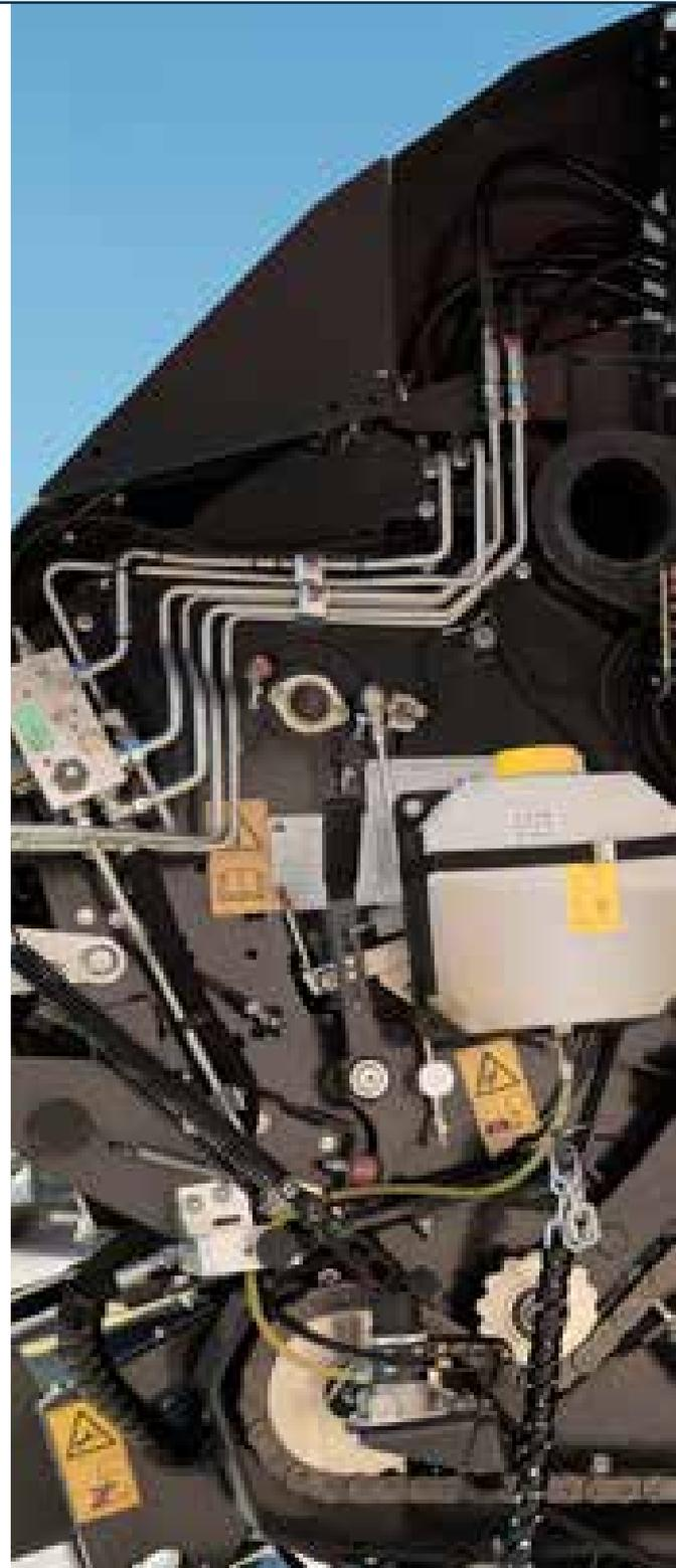
Keine engen Kurven und große Zahnräder tragen zu einer effizienten Kraftübertragung und einer langen Lebensdauer der Komponenten bei.
