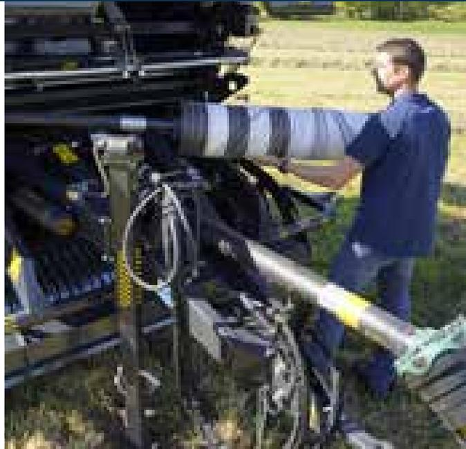
Die sehr niedrige Ladehöhe und die einfache Einfädelung des Netzes bedeuten minimale Standzeiten und maximale Presszeit.
