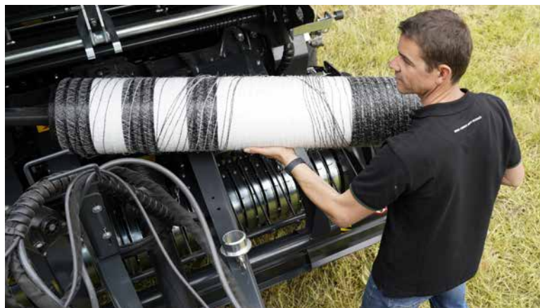
La hauteur de chargement très basse et le système très simple de liage permettent des temps d'arrêt plus courts et laissent plus de temps pour le pressage.
