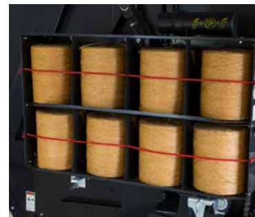
Capacité de stockage de huit bobines de ficelle.
