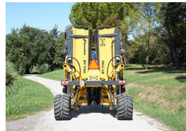
Le Kverneland ROC ST 730 peut être replié à une largeur de seulement 2,5 mètres pour le transport
