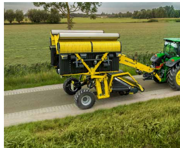
Un châssis de transport suspendu offre une solution optimale pour le transport routier.
