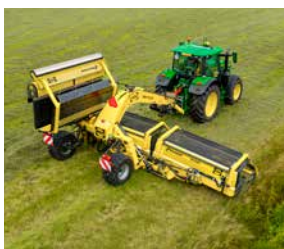
Le travail partiellement replié permet de ramasser de petits andains ou simplement de les retourner.
