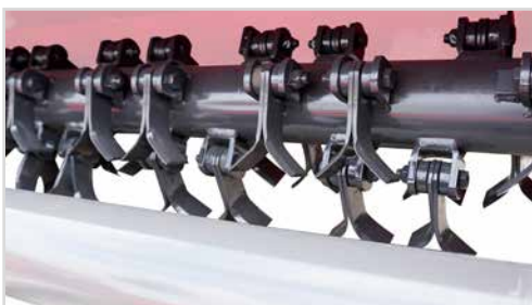
Alta velocidad tangencial del rotor combinada con cuchillas universales consiguen los mejores resultados para el mantenimiento de praderas y el picado de rastrojos. Cada rotor se equilibra dinámicamente antes de salir de fábrica.
