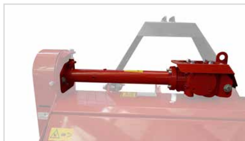
Todos los grupos de transmisión de la gama de picadoras Kverneland incorporan de serie un sistema de protección de rueda libre integrada.
