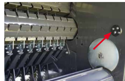
Czujnik wilgotności umieszczony wewnątrz komory prasowania.
