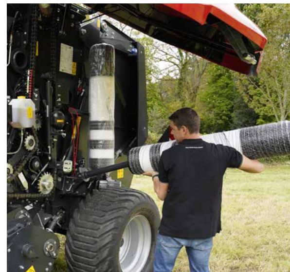
Wygodny system przechowywania rolek siatki umożliwia łatwy załadunek poziomy.
