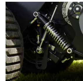
Zintegrowane zawieszenie podbieracza zapewnia dokładne kopiowanie terenu.
