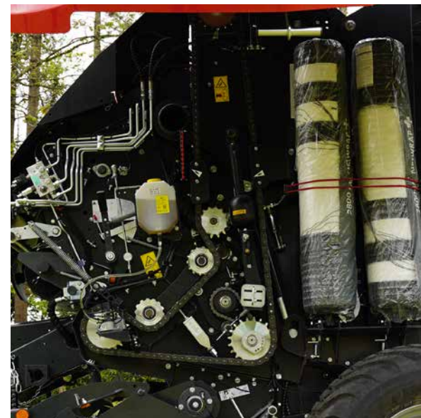
Pionowy magazyn rolek siatki zapewnia łatwy dostęp do napędów prasy.
