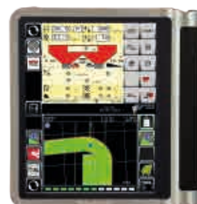
Alarme de régime des disques intégrée au boîtier Tellus GO+ et PRO
