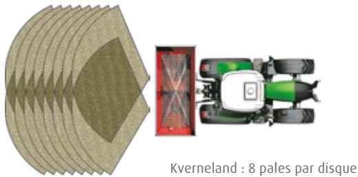
Kverneland : 8 pales par disque
