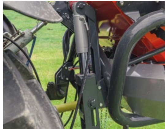
Vérin d'inclinaison - projection de l'engrais vers la bordure depuis le premier passage de traitement (uniquement sur modèles polyculture élevage)
