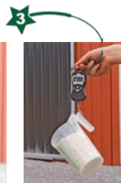
Déterminer le poids spécifique de l'engrais
