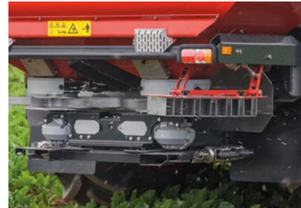
Déflecteur ExactLine - projection de l'engrais vers la bordure depuis le premier passage de traitement (disponible sur les modèles polyculture élevage & grande culture)
