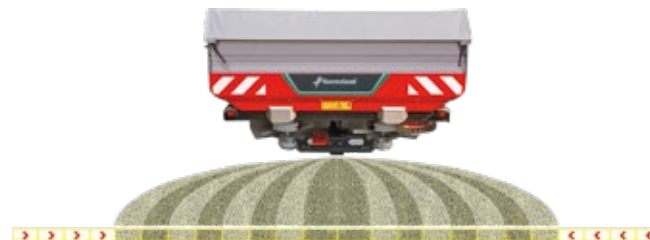
Diminution de la largeur d'épandage de 8 mètres des deux côtés
