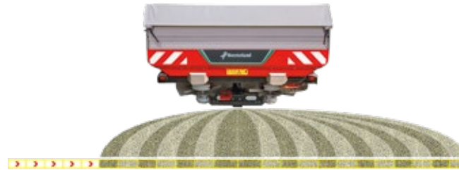
Diminution de 10 mètres de la largeur d'épandage sur la gauche
