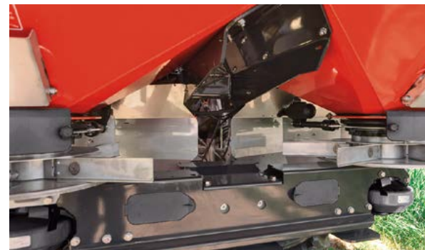
En elektrisk aktuator for å kontrollere påføringshastigheten
