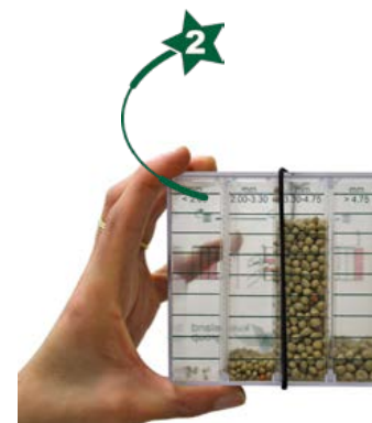
Bestem granulat størrelse og fordeling
