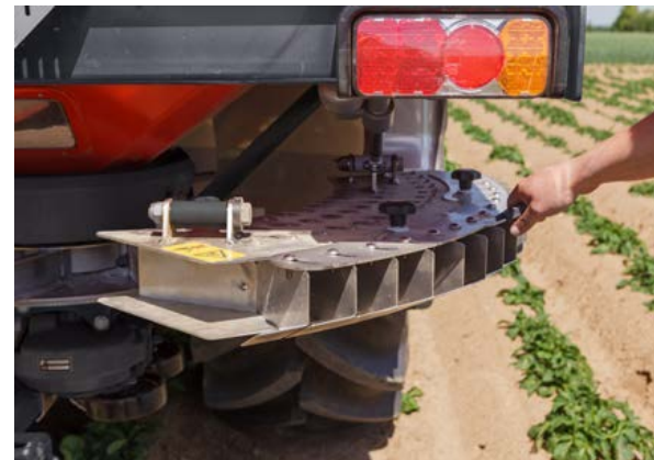
Spredning av grenselinje - spredning til grensen med ExactLine
