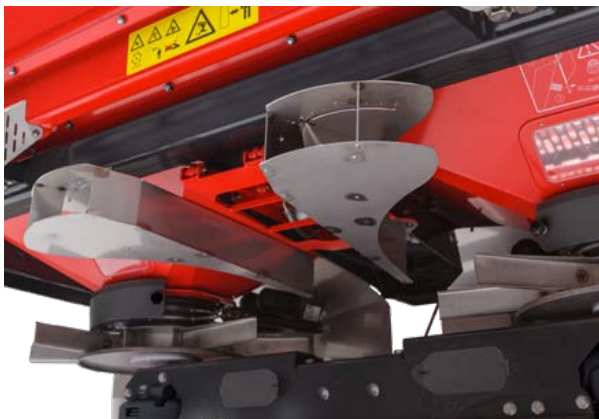
Ensidig kantspredning - spre fra kanten med kantspredningsplaten
