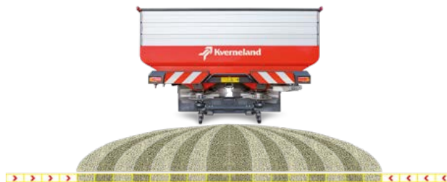
Redusere spredningsbredden på begge sider med 8 m
