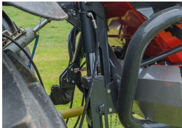
Kant spredning med kantspredingssylinder - spre mot grensen fra siste spor
