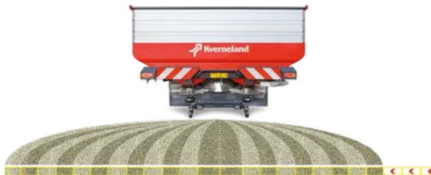
Redusere spredningsbredden på høyre side med 6 m
