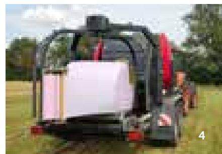
Der Wickeltisch bewegt sich schnell zu den Vorstreckern und der Wickelvorgang beginnt sofort.
