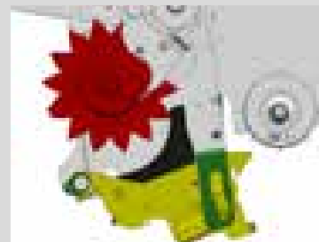
Schneidwerksboden in vollständig abgesenkter Position.
