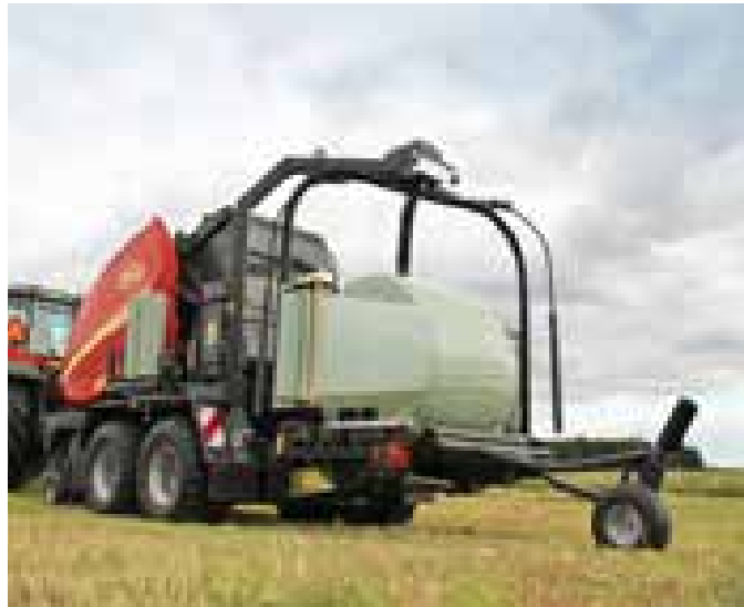
Doppel-Satellitenwickler mit 2 Vorstreckern und 4 endlosen Bändern für schnelles und stabiles Wickeln.
