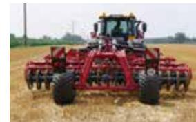
Une conversion facile de la position de travail à la position de transport. Le repliage hydraulique en deux parties offre une largeur de transport de 2,75 m maximum. La suspension hydraulique garantit une conduite régulière et un transport sur route en toute sécurité.
