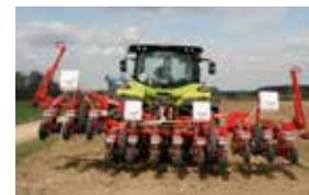
Les châssis de Monopill à repliage hydraulique en 6m ou 9m permettent de passer de la position de travail à la position de transport très rapidement depuis la cabine du tracteur. Ceci garantit la sécurité du transport routier.
