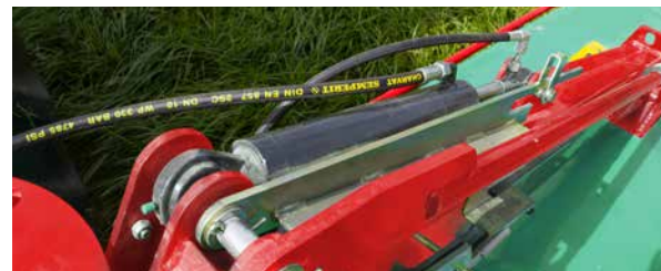
Relevage en bout de champ par vérin hydraulique.
