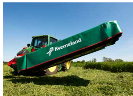
Manœuvres en fourrière aisées grâce à un vérin hydraulique avec un grand dégagement.
