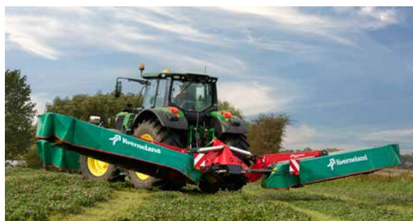
Dégagement important au-dessus des andains lors des manœuvres en fourrière.
