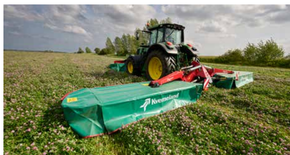
Articulation centrale des unités de coupe pour un suivi parfait des contours du terrain.
