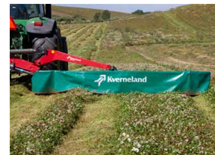
Pour éviter de rouler sur les cultures fauchées, un kit double andains est disponible en option pour les modèles 2836 M et 2840 M.
