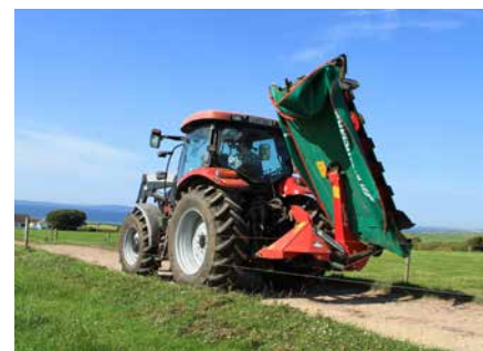
Un transport en position verticale à 125° pour un parfait équilibre derrière le tracteur.
