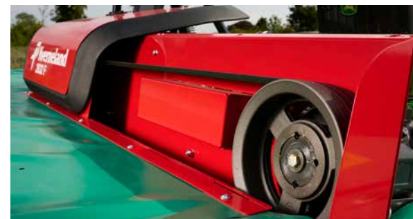
Accès rapide et facile aux courroies d'entraînement
