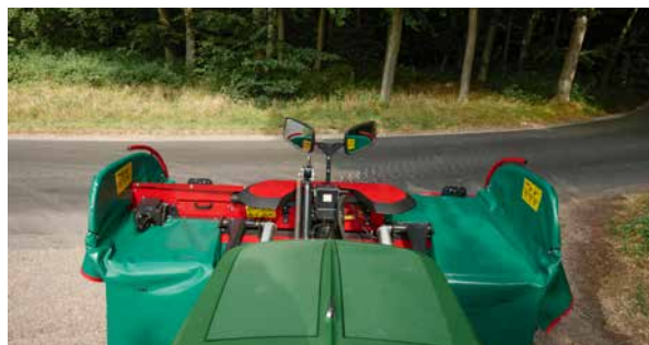
Bonne visibilité sur la machine depuis la cabine du tracteur. Rétroviseurs disponibles en option.
