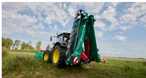
Transport en position verticale pour une répartition du poids parfaite.
