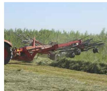
Die maximale Aushubhöhe am Vorgewende ist enorm. Bei Bedarf kann die Hubhöhe am Vorgewende individuell eingestellt werden.
