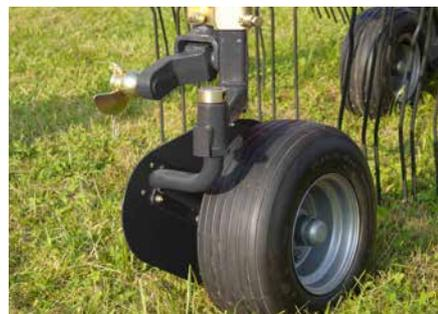
Für eine optimale Bodenanpassung können die Schwader optional mit einem zusätzlichen Stützrad ausgestattet werden.
