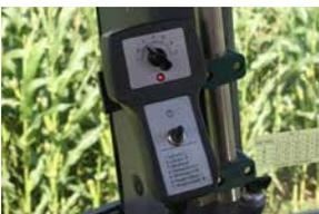
Der Andex 1104 verfügt über eine Bedienbox, die alle Funktionen der Maschine steuert. Über einen Vorwählschalter kann die jeweilige Funktion gewählt und mit dem Steuergerät ausgeführt werden.
