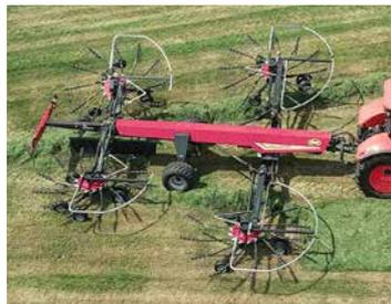
Eine elektrische Höheneinstellung ist für den AnDEX 1304 Pro verfügbar. Der Fahrer kann hier individuell einen Null-Punkt für die Rechhöhe der einzelnen Kreisel setzen. Dies ist die Grundlage für perfektes Grundfutter.
