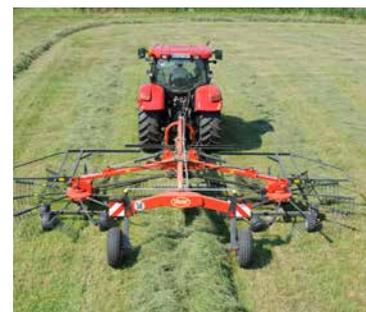
Für eine reduzierte Transport- und Abstellhöhe lassen sich beim Andex 764 die Zinkenarme demontieren. Das Schwadttuch klappt automatisch ein.
