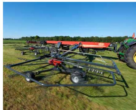
Das TerraLink Quattro System bietet perfekte Bodenadaptation der Kreisel in alle Richtungen. Dies wird durch einen flexiblen Träger zwischen Mittelrahmen und dem Rotor in Verbindung mit dem Quattro-Konturfahrwerk gewährleistet.
