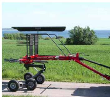
Mit der Ackerschienenanhangung können die Andex 424T und Andex 474T hinter sehr kleinen Traktoren eingesetzt werden.
