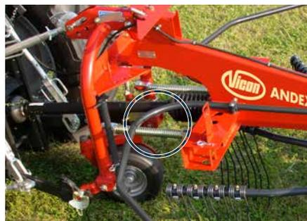
Schwingungsdämpfer für ein exzellentes Nachlaufverhalten.
