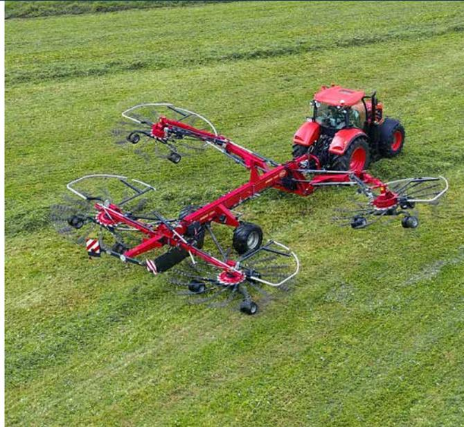
Werden schon bearbeitete Flächen überfahren, heben die einzelnen Kreisel automatisch an diesen Stellen aus bzw. setzen vor nicht bearbeiteten Flächen rechtzeitig wieder ein.
