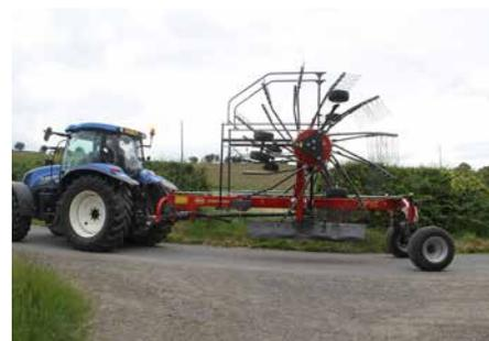
Der Andex 804 hat eine Transporthöhe von unter 4,00 m, ohne dass der Fahrer die Schlepperkabine verlassen muss. Auf der Straße und im Feld ist er enorm wendig.
