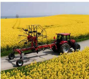
Die Vicon Mittelschwader lassen sich für den Transport bequem vom Schleppersitz aus hydraulisch in Transportposition bringen.
