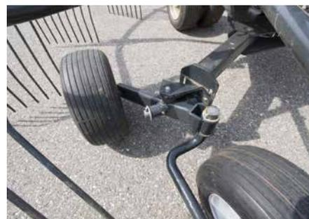
Optionale Tandemachse für zusätzliche Stabilität speziell am Hang.
