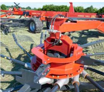
Die Arbeitshöhe eines jeden Rotors kann individuell eingestellt werden.
