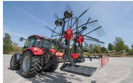
Kompakte Transportabmessungen. Zinkenarme müssen für den Transport nicht abgenommen werden.
