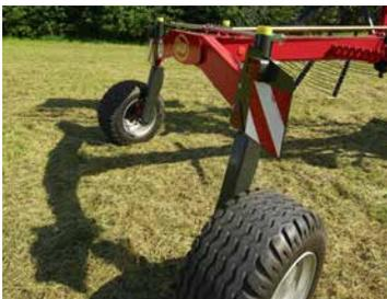
Das aktiv gesteuerte Fahrwerk Vicon AnDEX 774, sichert einen spurtreuen Nachlauf.
