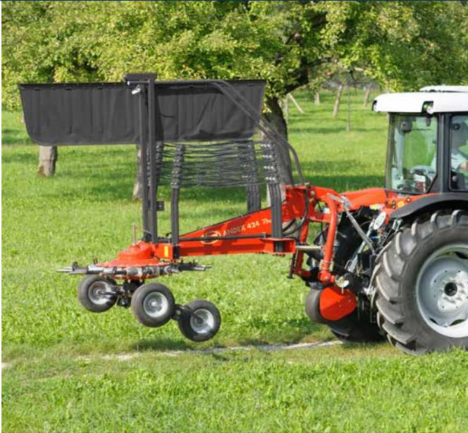
Die stabilen Schutzbügel werden nahe am Hauptrahmen hoch geschwenkt und automatisch verriegelt. Das Schwadttuch selbst ist drehbar aufgehängt, damit es in Transportstellung nach unten pendeln kann.
