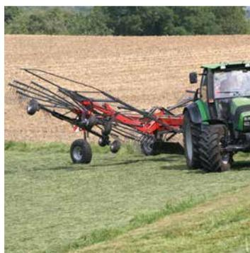
Die aktive Radsteuerung ermöglicht enge Kurvenfahrten am Vorgewende.
