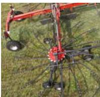
Der AnDEX 1104 ist serienmäßig mit Tandemachsen und hydraulischer Höheneinstellung der Kreisel ausgestattet.
