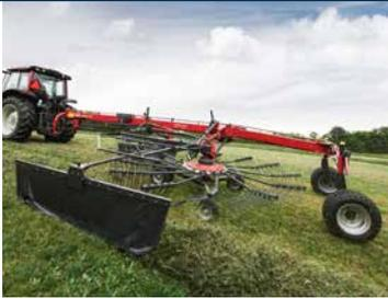
Optional hydraulisch klappbares Schwadttuch verfügbar.
