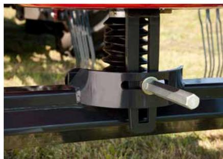
Stufenlos verstellbare Kurvenbahn für optimale Ergebnisse unter allen Bedingungen.
