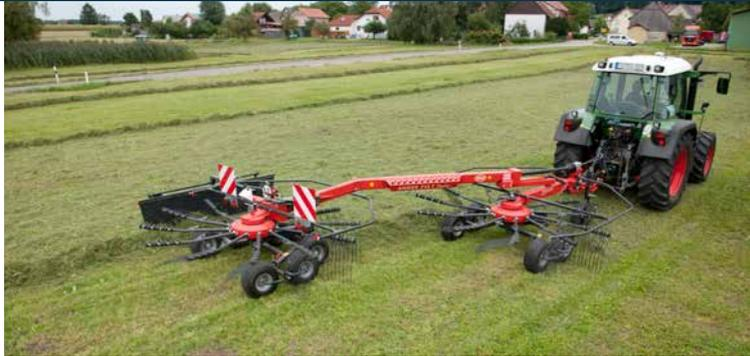
Der Andex 714T VARIO mit 7,10 m Arbeitsbreite und dem patentierten SideShift.
