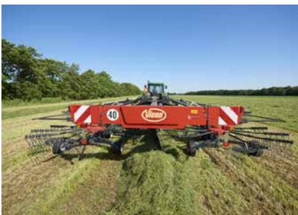
Die Arbeitsbreite und die Schwadbreite werden hydraulisch eingestellt. Die Arbeitsbreite ist von 10,0 – 12,50 m wählbar und die Schwadbreite von 1,20 – 2,20 m.
