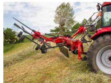
80° Einschlagwinkel dank aktiv gesteuertem Fahrwerk.
