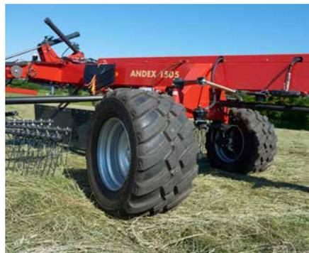
Für eine verbesserte Nachlaufeigenschaft kann der Andex 1505 optional mit einer hydraulisch lenkbaren Achse ausgestattet werden.
