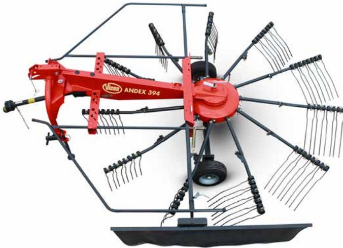
Der Andex 394 mit 3,90 m Arbeitsbreite für schnelle und effektive Recharbeit ; auch für das Schwaden von Stroh geeignet.
