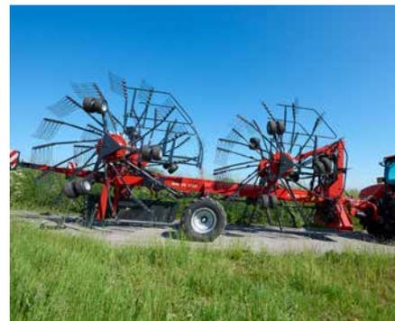
Trotz einem Kreiseldurchmesser von 3,85 m bleibt die Maschine in der Gesamthöhe unter 4,00 m! Die Zinkenarme müssen dafür nicht abgenommen werden.
