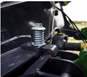
En cas d'obstacle le dispositif de sécurité Non-Stop protège le lamier.
