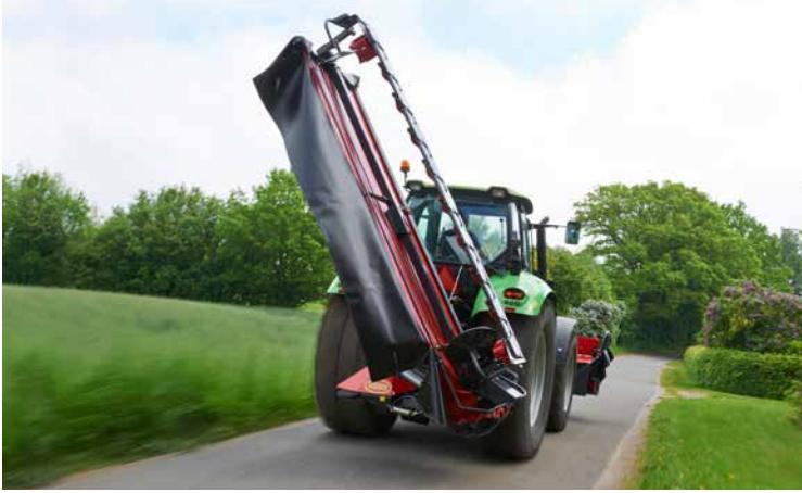
Position transport à 125° pour une excellente répartition du poids.
