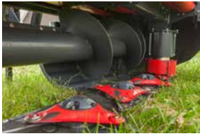
Dispositif d'andainage actif réalisant des andains structurés.
