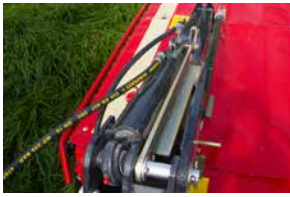
Relevage hydraulique en fourrière.
