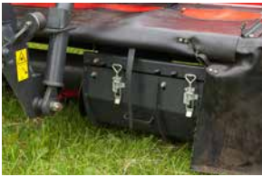
Die Schwadbreite wird einfach über verstellbare Leitbleche eingestellt.
