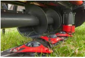
Aktiv angetriebene Schwadzusammenführung für ein perfektes Schwad.
