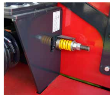
Leichte Einstellung der Keilriemenspannung
