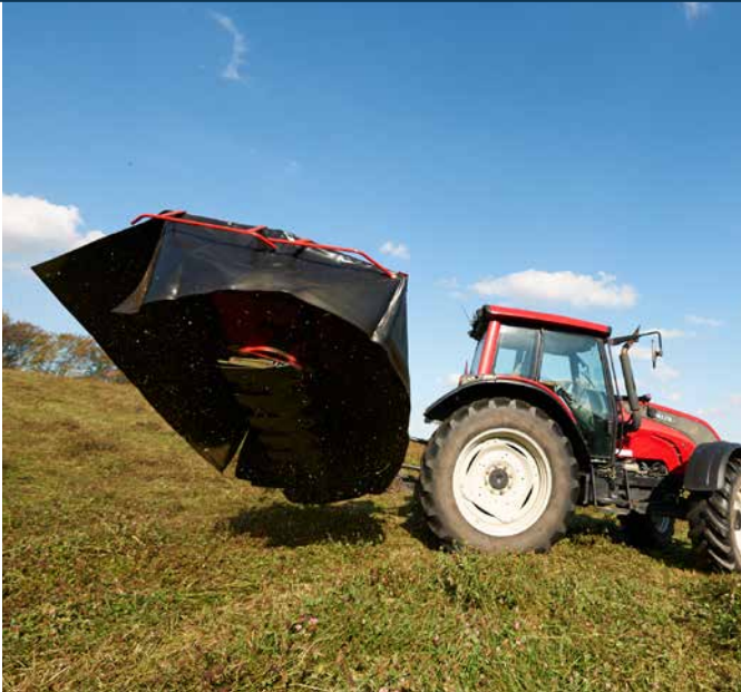
Der Aushub am Vorgewende erfolgt über einen Hydraulikzylinder.
