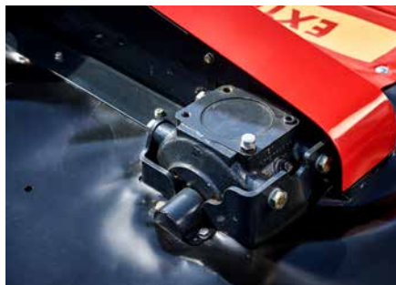
Die Drehrichtung kann wahlweise rechts- oder linksdrehend gewählt werden. (ab Werk)
