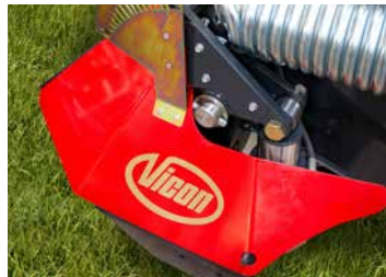
Hydraulisch einstellbare Bodendruckentlastung (Option).
