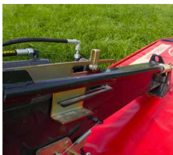
Perfekte Boden Anpassung durch die Mittenaufhängung.
