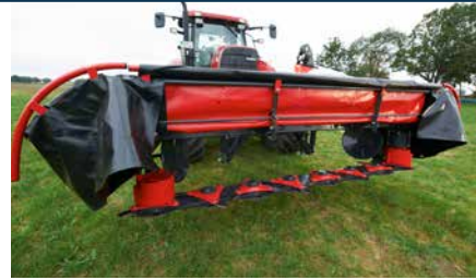
Optimaler Zugang zum Mähbalken durch klappbaren Front- und Seitenschutz.
