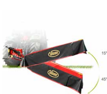
Böschungswinkel: 15° nach oben und 45° nach unten
