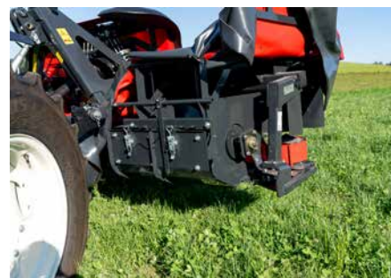
Die Schwadbreite wird einfach über verstellbare Leitbleche eingestellt.
