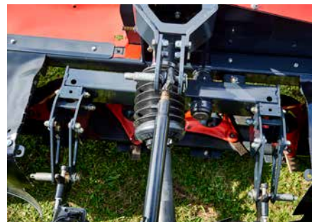
Die drehbare Unterlenkerschwinge hat einen Pendelweg von 20°.
