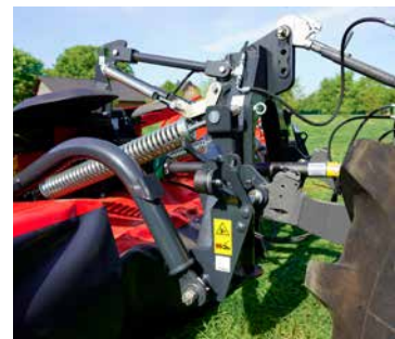
Direkter Anbau an die Fronthydraulik ohne Koppeldreieck
