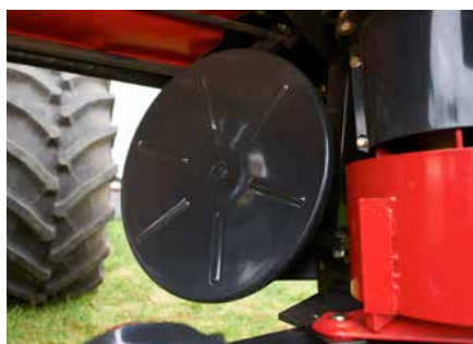
Die Maschinen sind mit zwei Schwadscheiben ausgestattet. Sie ermöglichen Schwadbreiten von 2,20-2,40 m.
