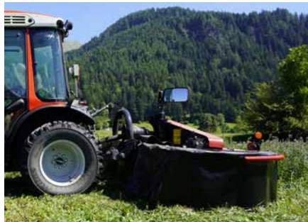
Der Schwerpunkt des Mähwerks ist nah am Traktor.
