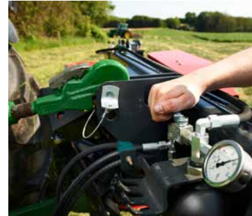
Der Auflagedruck kann auf dem Manometer abgelesen werden. (EXTRA 432H und 436H)
