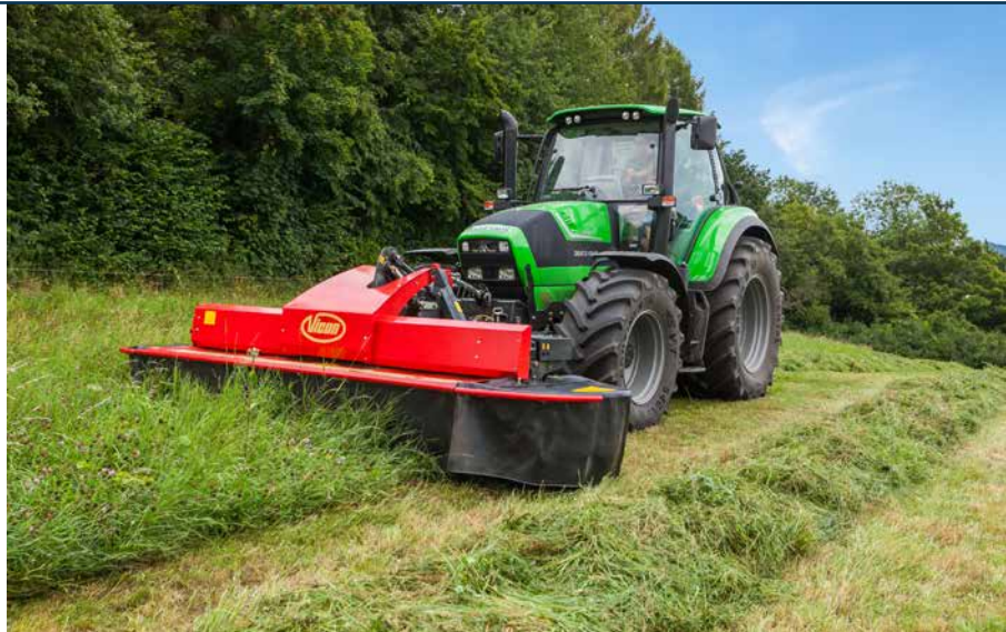
Das Schwad wird sauber kastenförmig abgelegt.
