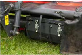
El ancho de hilera se cambia fácilmente desbloqueando las chapas hileradoras y deslizándolas a la posición deseada.
