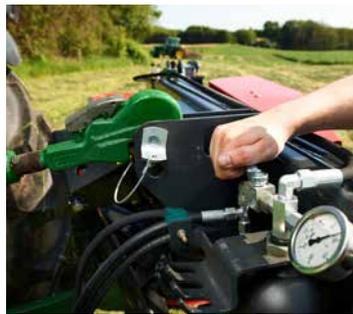
Ajuste hidráulico de la presión sobre el suelo (EXTRA 432H y 436H).
