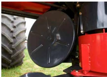
La segadora está equipada de serie con un disco hilerador a cada lado para hacer hileras de 2,40 m a 2,20 m.
