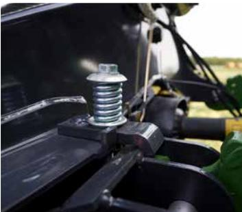
En caso de obstáculo, el dispositivo de seguridad Non-Stop protege la barra de corte.
