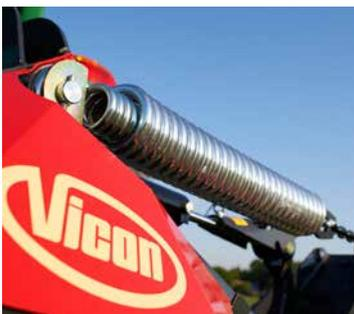
El muelle de gran diámetro proporciona una excelente flotación en todo el ancho de la segadora.
