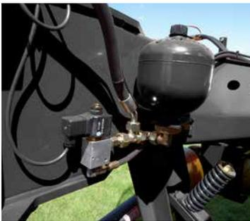
La suspensión hidráulica garantiza un ajuste preciso de la presión sobre el suelo (EXTRA 440H).
