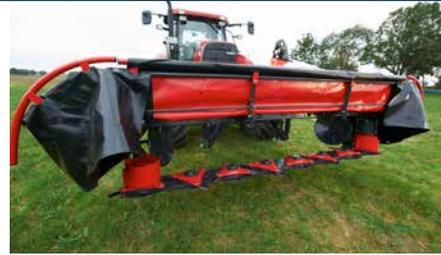
Acceso rápido y fácil a la barra de corte gracias a las protecciones delanteras y laterales plegables.
