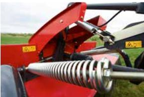
Dos muelles proporcionan un ajuste de la presión sobre el suelo.
