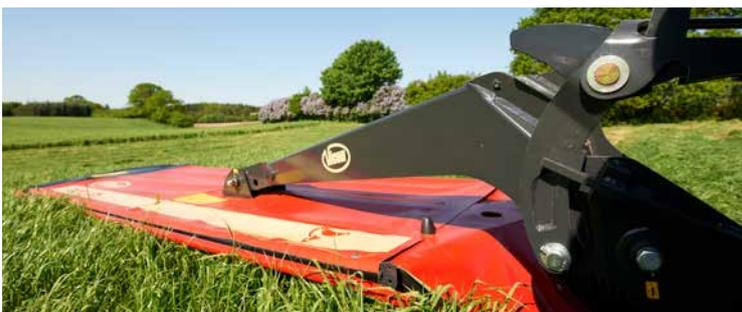
La articulación pendular permite una adaptación rápida y precisa a los diferentes contornos del suelo.
