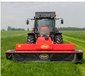
La transmisión de dos velocidades es estándar en la EXTRA 332XF. La velocidad estándar es de 1000 rpm. Con invertir las poleas de transmisión se trabaja a 750 rpm, para reducir el consumo de combustible.
