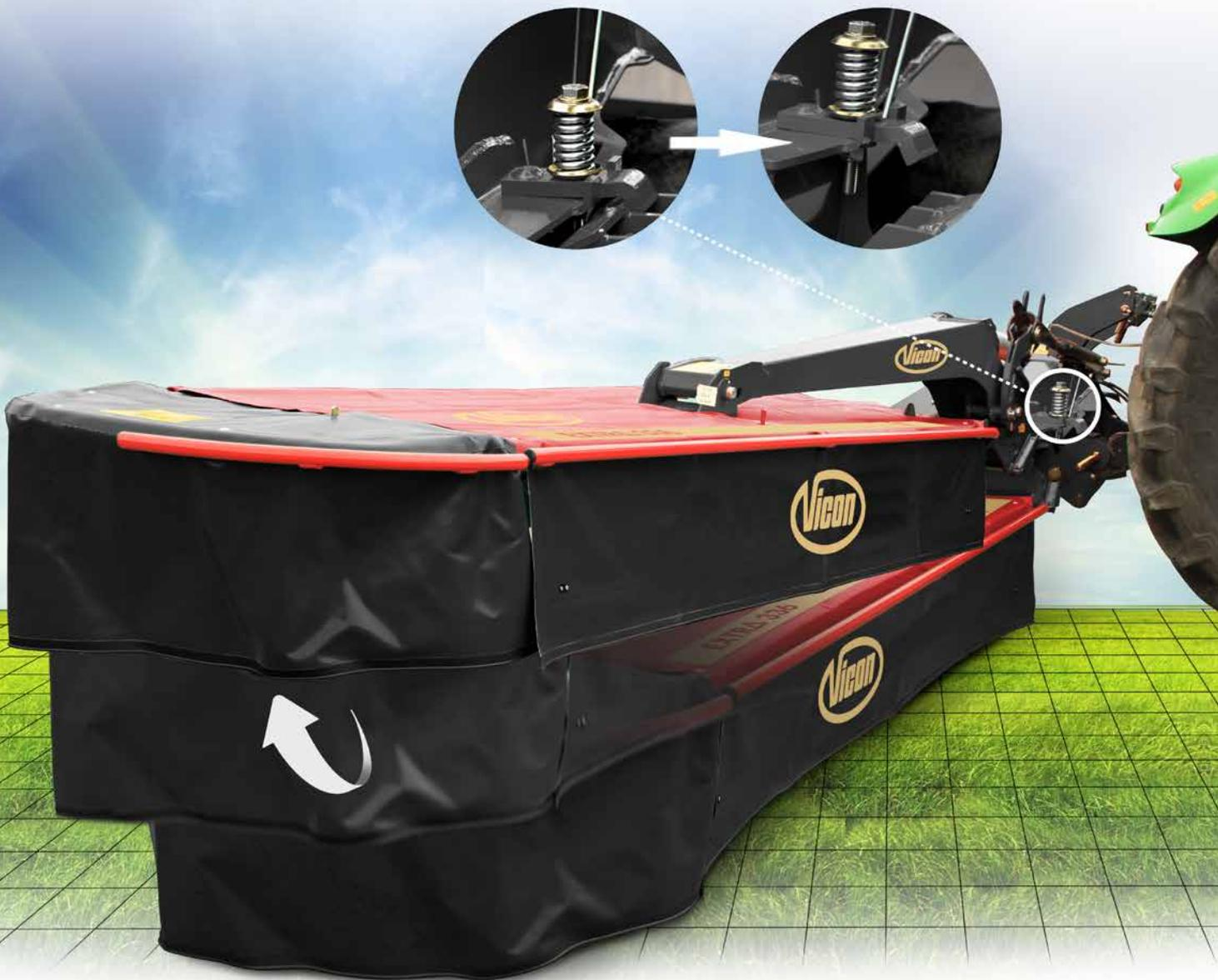
En caso de obstáculo, el sistema de seguridad Non-Stop se activará permitiendo a la máquina esquivar el obstáculo ...
