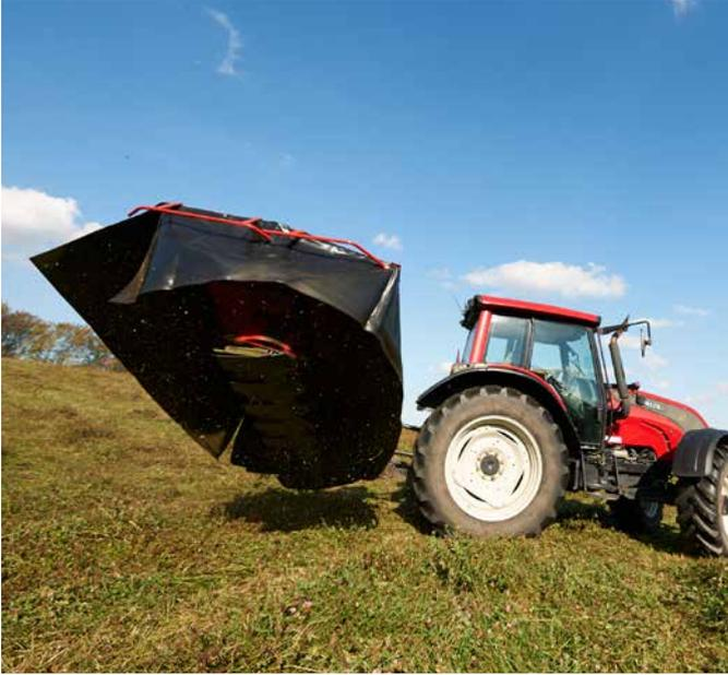
Elevación en cabecera mediante un cilindro hidráulico.
