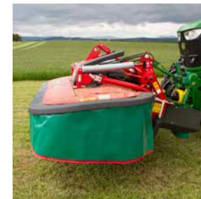
Garde au sol généreuse de 420 mm pour des manœuvres aisées en bout de champ afin de passer les andains sans les endommager.
