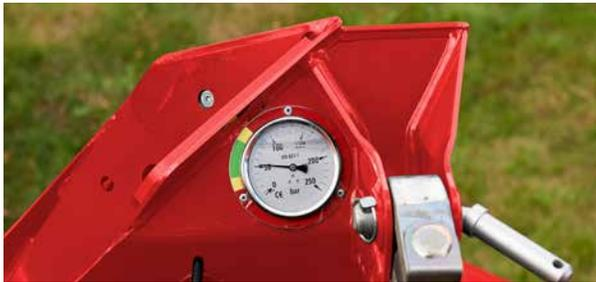
La pression au sol de la série Kverneland 3300 est facilement réglable depuis le poste de conduite, grâce à un dispositif hydraulique qui inclut une échelle graduée facile à lire.
