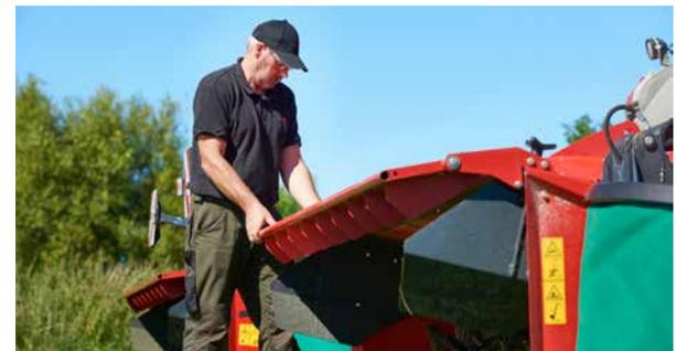
Les tôles d'andainage sont facilement coulissées sur le côté et les vannes d'épandage FlipOver sont tournées à 180°. Aucun outil n'est nécessaire.
