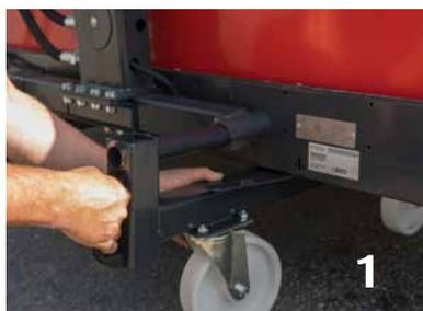
Faites coulisser les roulettes de transport spécialement conçues sur le tapis BX et retirez l'axe de fixation.
