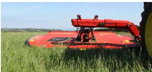
La position de l'unité de fauche peut être réglée en continu 50/50% de répartition du poids. Dans une fourchette de 150 mm sur le bras porteur, ce qui permet d'adapter la position de la faucheuse à la largeur de travail de celle-ci montée à l'avant ou à la voie du tracteur.
