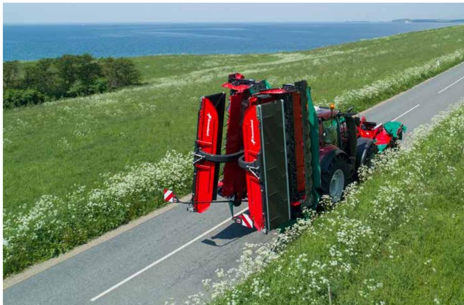
La faucheuse se replie en position de transport à plus de 90°, ce qui permet d'éloigner les unités de coupe de la cime des arbres.
