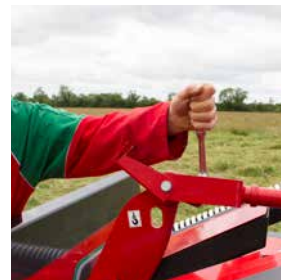
Réglage de la hauteur de coupe intégré à la suspension.
