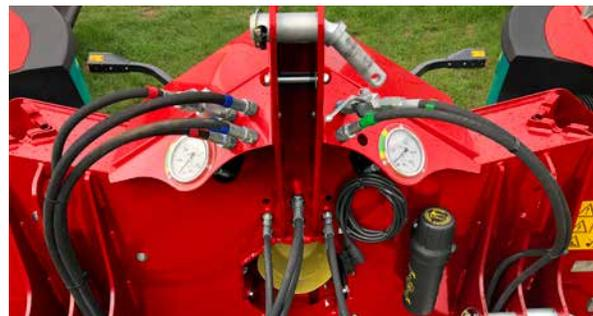
Toutes les fonctions hydrauliques sont contrôlées par les distributeurs du tracteur en combinaison avec un boîtier de présélection PilotBox.
