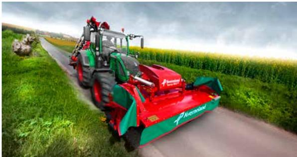
En plus, ces machines sont équipées d'une vitesse variable du rotor conditionneur, pour **s'adapter aux différentes conditions de récolte** - Toutes ces fonctionnalités font de cette machine une solution très professionnelle.
