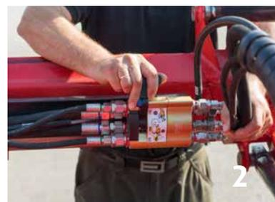
Débranchez le câble d'alimentation et les flexibles hydrauliques du tapis BX avec un seul levier.
