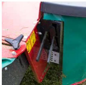
Double réglage de la tôle de conditionnement.
