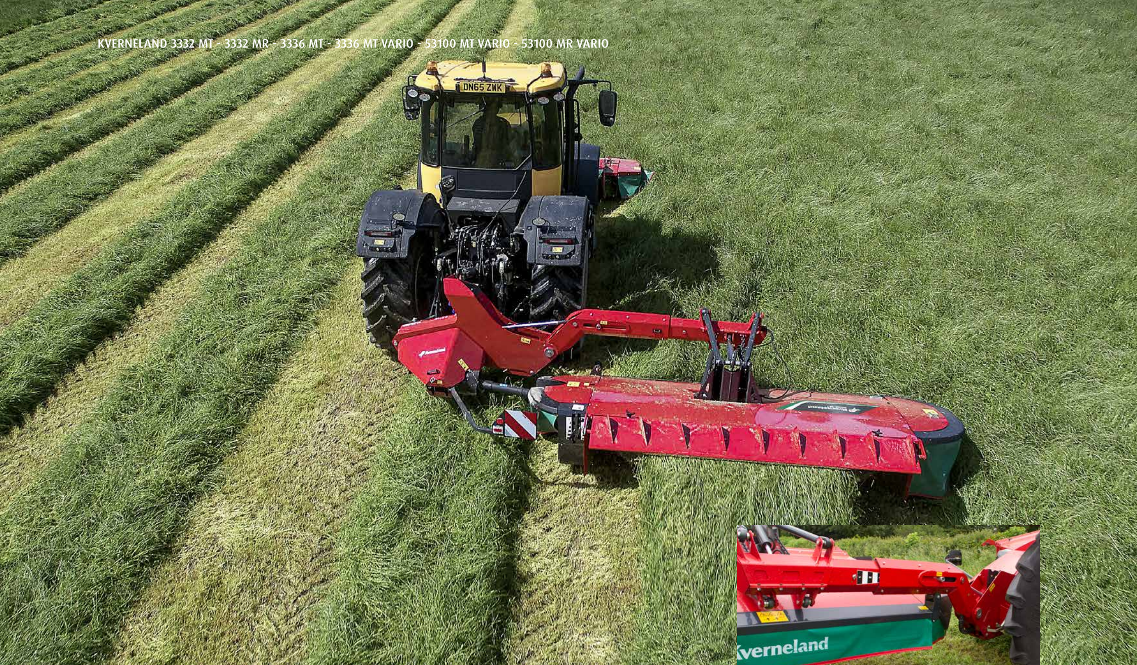
Le recouvrement et la largeur de travail sont réglés hydrauliquement sur les modèles Vario.
