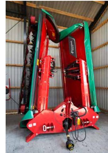
La faucheuse est fermement déposée sur des pieds de stationnement solides et stables, ce qui ramène la hauteur totale à moins de 4,00 m.
