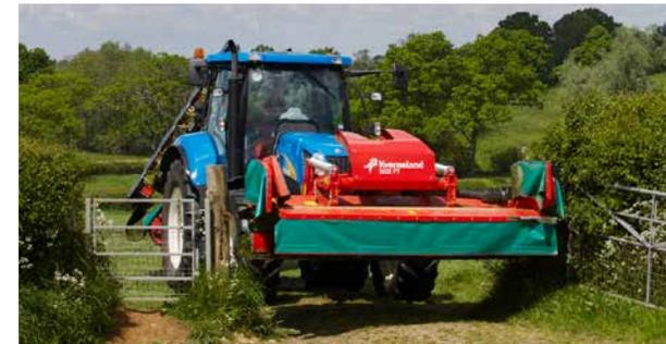
Les protections latérales sont repliables pour réduire la largeur au transport.
