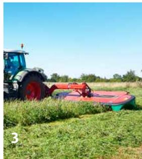
1. Dégagement au sol **minimum de 500 mm** sur l'ensemble de l'unité de fauche pendant les manoeuvres en bout de champ. L'unité de fauche est relevée et le bras porteur est incliné à un angle de 10°.
