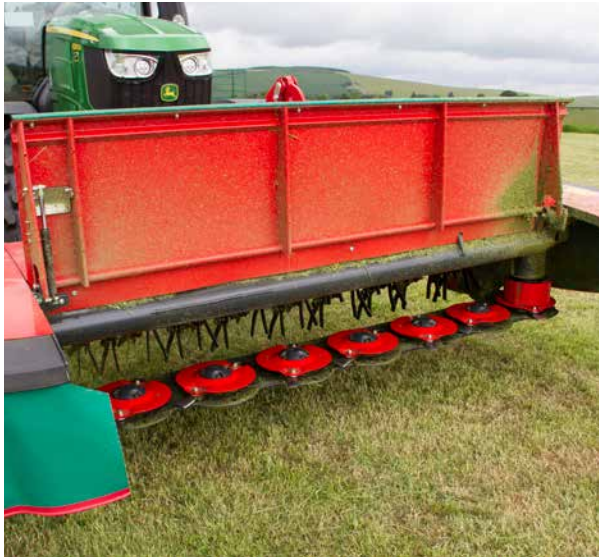
Accès facile pour inspection et service. Le capot frontal s'ouvre en position verticale via un vérin hydraulique.
