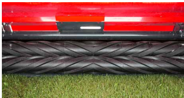
Double entraînement des rouleaux
