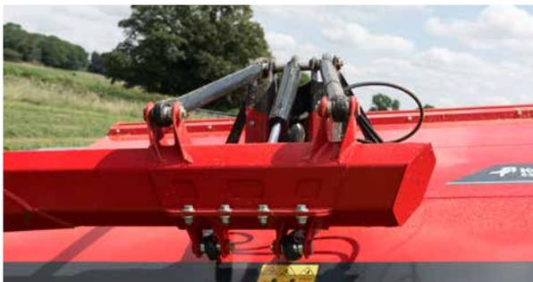
La position des unités de fauche peut être réglée en continu dans une fourchette de 150 mm sur le bras porteur pour s'adapter à la largeur de travail de la faucheuse frontale.
