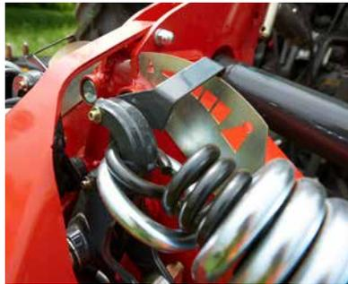
Ressorts de suspension de large section, réglables hydrauliquement, en option.
