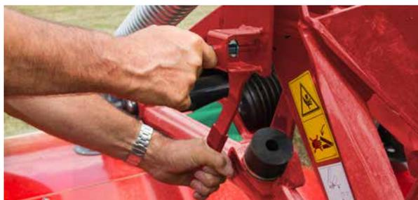
Béquille de stationnement à une poignée, pour verrouiller et préparer la machine au dételage.
