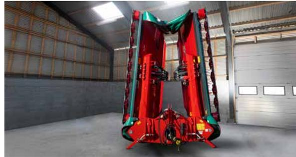
Grâce au dispositif de stationnement intégré, le stockage est facile et pratique, nécessitant un minimum d'espace pendant l'hivernage. La faucheuse est solidement remise sur des pieds de stationnement robustes et stables, ce qui ramène la hauteur totale à moins de 4,00 m.
