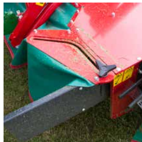
Tôles d'andainage intégrées, facilement ajustables pour corriger la largeur de l'andain.
