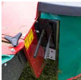
Double réglage de la tôle de conditionnement.
