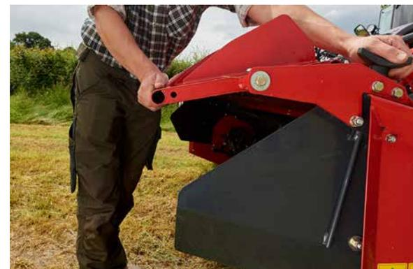
Les tôles d'andainage se déploient automatiquement lorsqu'elles sont glissées vers l'intérieur pour permettre un andainage efficace et précis.
