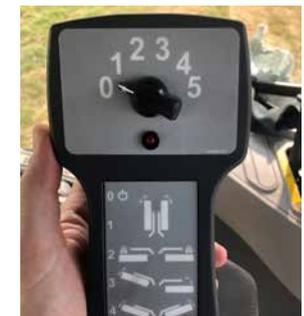
Les Kverneland 5387 et 5395 sont faciles à manipuler et fonctionnent en standard avec un boîtier de présélection PilotBox pour la montée/descente (individuelle) des unités de coupe et des tapis et le réglage de la pression au sol.
