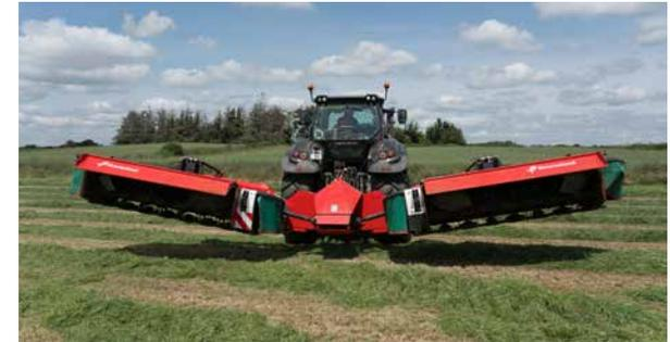
Dégagement au sol minimum de 500 mm sur l'ensemble de l'unité de fauche lors des manoeuvres en bout de champ. L'unité de fauche est relevée et le bras porteur est incliné à un angle de 10°.
