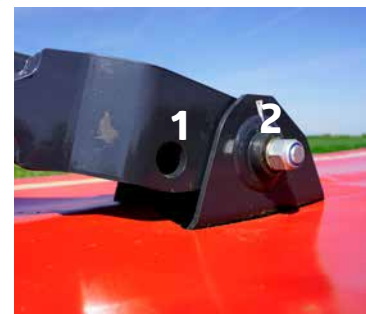
Twee montageopties voor optimale overlap bij toepassing van een frontmaaier.
