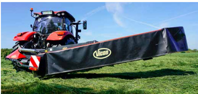
Uitheffen op de kopakker m.b.v. hydraulische cilinder - ruime bodemvrijheid.
