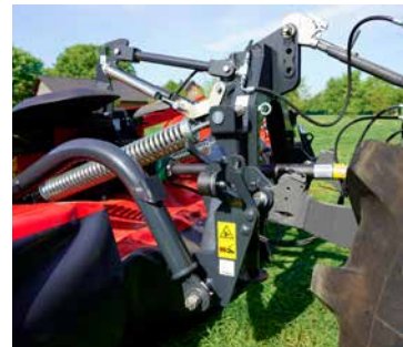
Directe koppeling aan tractor – geen extra A-frame nodig.
