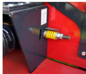
De riemspanner is goed zichtbaar voor controle en afstelling.
