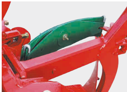
zabezpieczenie typu HD z 9 resorami (900 kg)
