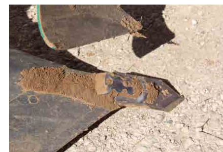
Kształt dłuł Knock-On zabezpiecza inne elementy.
