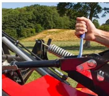
Le réglage de la hauteur de coupe est intégré directement dans le système de suspension.
