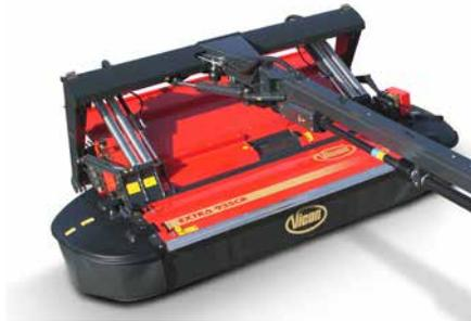
Les modèles EXTRA 936 sont équipés de 4 ressorts de suspension pour une pression au sol parfaite.
