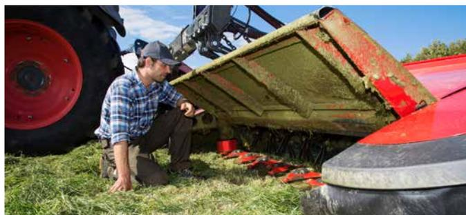
L'accès au lamier est aisé et rapide, facilitant l'inspection quotidienne des disques et des couteaux.
