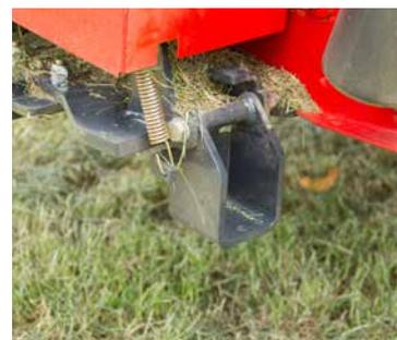
La béquille de stationnement est facilement activée et maintient parfaitement la faucheuse.
