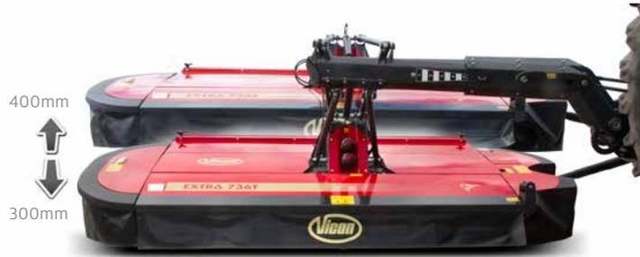
Système de suivi du sol exceptionnel. Les quatre bras de suspension se relèvent de 400 mm et se baissent de 300 mm pour un suivi précis.
