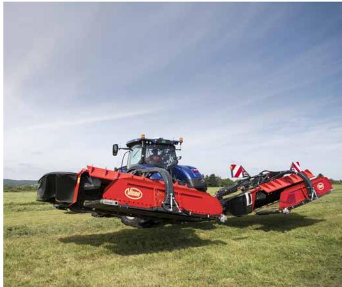
Dégagement suffisant pendant les manœuvres en fourrière. Lorsque les tapis sont relevés, ils s'arrêtent automatiquement.
