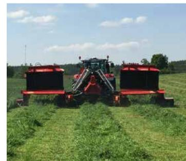
Quand le tapis n'est pas utilisé il est relevé hydrauliquement au-dessus de l'unité de coupe. Tout ce que vous devez faire, c'est de presser le bouton du boîtier de commande.
