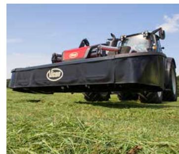
Garde au sol généreuse de 420mm pour des manœuvres aisées en bout de champ afin de passer les andains sans les endommager.
