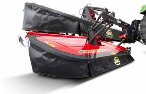
Sécurité Non-Stop – En cas d'obstacle, l'unité de fauche recule puis se relève, même sur le côté intérieur de la faucheuse, puis revient en position de travail une fois l'obstacle passé. Aucun arrêt nécessaire – aucune perte de temps.
