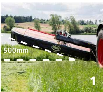
Distance minimale de 500 mm par rapport au sol, des unités de fauche lors des manœuvres en fourrière. L'unité de fauche est levée et le bras porteur incliné de 10 °.
