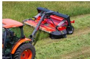
Les manœuvres en fourrière sont facilitées grâce au timon hydraulique offrant des rayons de braquage considérablement réduits.
