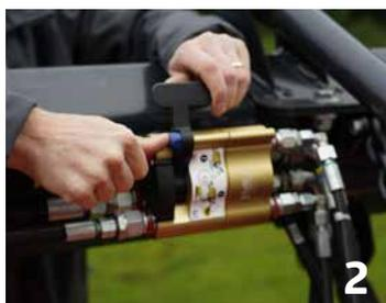
2 Débranchez le câble d'alimentation et tous les raccords hydrauliques du tapis BX à l'aide d'un seul levier.
