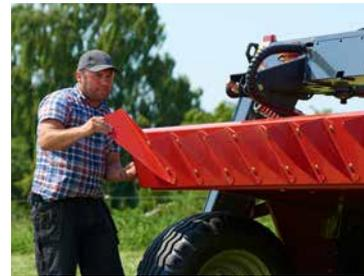
Le passage en position andainage à la position épandage large, se fait par la simple rotation à 180° du support des volets éparpilleurs (sans aucun outil).
