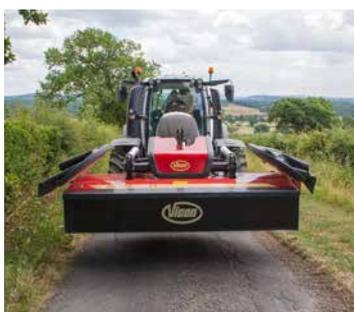
Repliage hydraulique des protections FlexProtect (en option).
