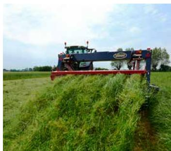
Une répartition du fourrage parfaite grâce au système d'épandage large.
