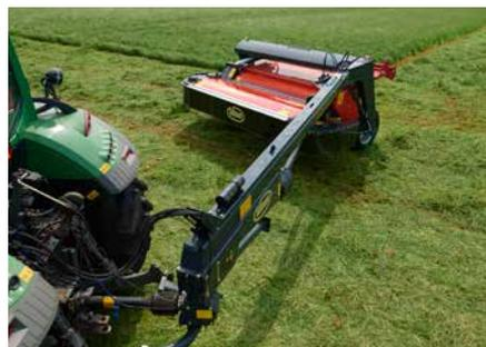
La tête pivotante offre un confort optimisation des manœuvres en fourrière.
