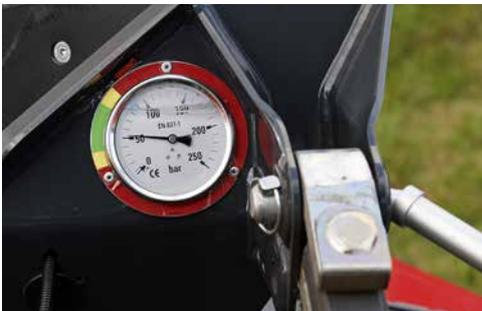
La pression au sol se règle facilement depuis le siège du tracteur, grâce à un dispositif hydraulique qui inclut une échelle graduée facile à lire sur la faucheuse pour une vraie aide à la conduite.
