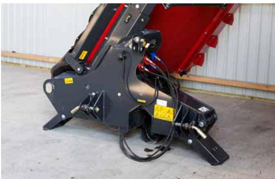
En stationnement normal ou en remisage hivernal, les bras d'attelage sont systématiquement en position horizontale, facilitant l'attelage et le dételage de la faucheuse du tracteur.
