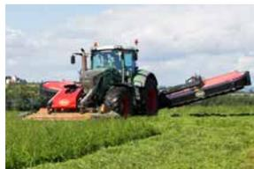
Réglez la hauteur de levage en fourrière. Dans des conditions de faible densité de récolte, la hauteur de levage des unités de fauche peut être réduite.
