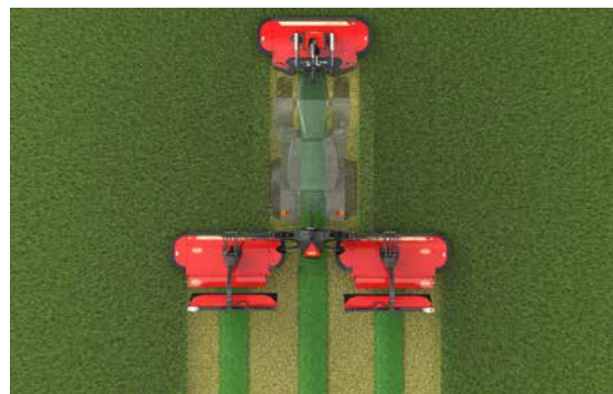
Einzelne Schwade mit den werkzeuglos einstellbaren Schwadleitblechen
