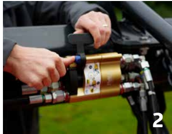
Die Hydraulikanschlüsse werden getrennt.
