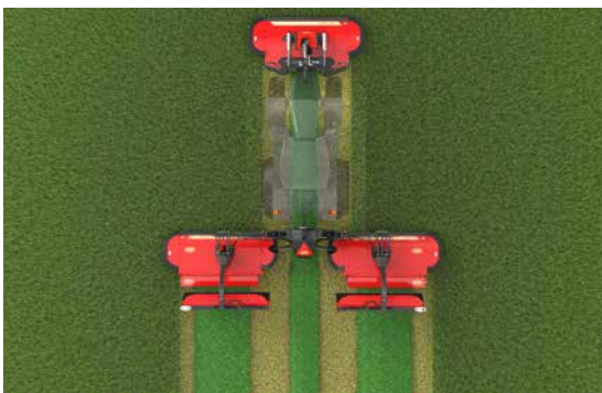
Breitablage über die Arbeitsbreite der Mäheinheiten
