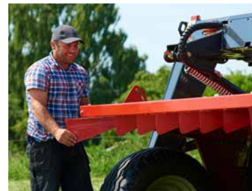
Die beiden Schwadleitbleche werden ausgebaut.
