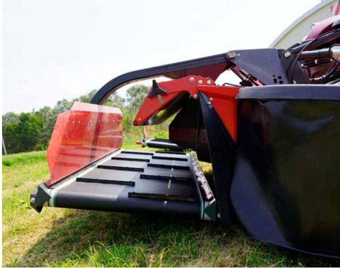
Die breiten Bänder ermöglichen die Handhabung großer Erntemengen.
