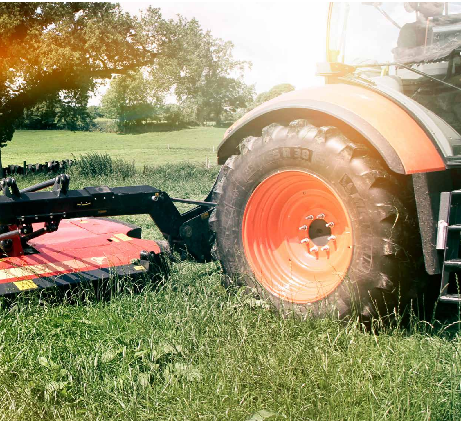
Mähwerke mit Aufbereiter 3,18 m Arbeitsbreite
