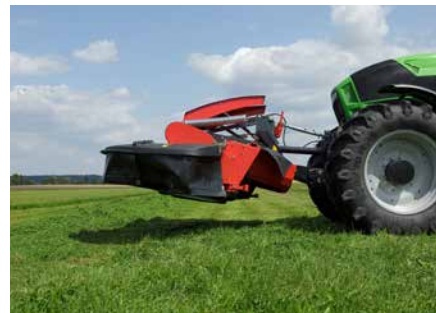
350 mm Aushubhöhe am Vorgewende
