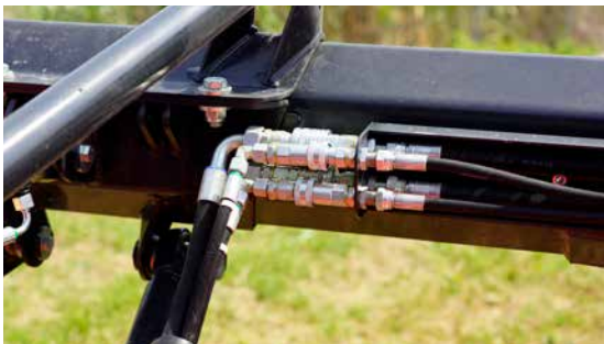
Die Schwadförderbänder können bei Nichtgebrauch einfach abgekoppelt und entfernt werden – das spart Gewicht und Kraftstoff.
