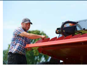
Einfache Umstellung von Breit- auf Schwadablage bei EXTRA 900
