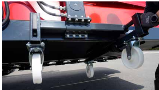
Optionale Transportrollen sind erhältlich, um die BX-Bänder bei der Lagerung sicher zu parken.
