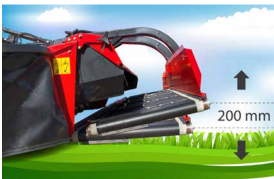
Das Schwadverlegeband kann in der Höhe hydraulisch um 200 mm verstellt werden.
