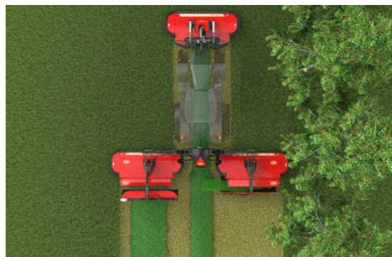
Verwendung eines Bandes, um das Erntegut vom Feldrand wegzubewegen
