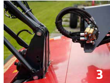
Der Verriegelungsbolzen wird gezogen und die Einheit abgesenkt.
