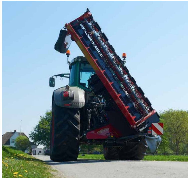
Das EXTRA 736T Vario in Transportstellung. Der hydraulisch teleskopierbare Auslegearm wird hierzu in die unterste Position gefahren.
