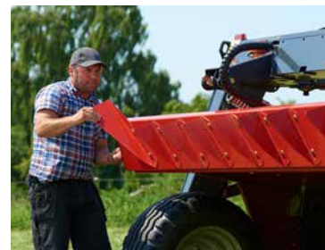
Einfache Umstellung von Breit- auf Schwadablage bei EXTRA 900
