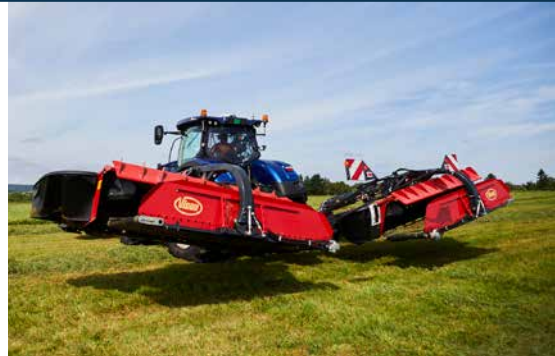
Große Aushubhöhe am Vorgewende. In der Vorgewendeposition stoppen die Bänder automatisch.
