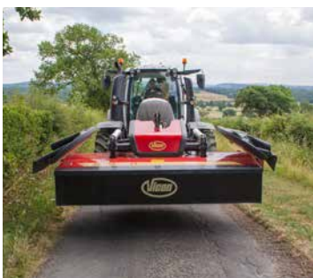
Hydraulische Klappung der seitlichen Schutzabdeckung (Option)
