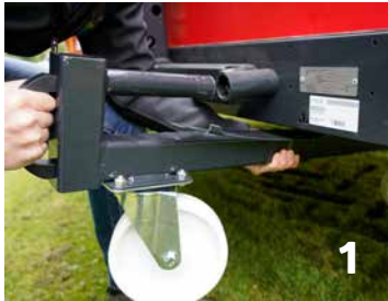
Die Transportrollen werden eingesetzt.
