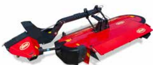
Mähwerke mit Aufbereiter 3,18 m Arbeitsbreite
