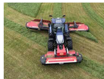
Wird eine Einheit angehoben verringert sich die Bandgeschwindigkeit dieser Einheit.
