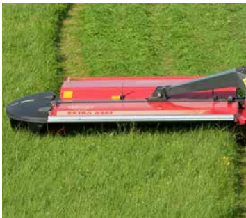
Die Mittenaufhängung garantiert einen gleichmäßigen Auflagedruck über die gesamte Arbeitsbreite.
