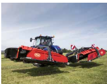
Große Aushubhöhe am Vorgewende. In der Vorgewendeposition stoppen die Bänder automatisch.
