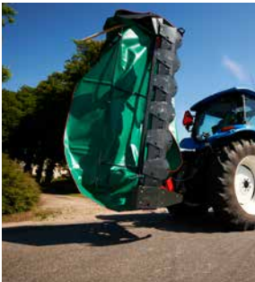
2300-serien foldes hydraulisk op til lodret position for transport.
