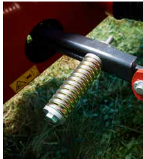
BreakBack-systemet beskytter knivbjælken, når der køres mod forhindringer.
