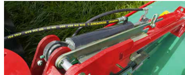
Løft med hydraulikcylinder i foragre.
