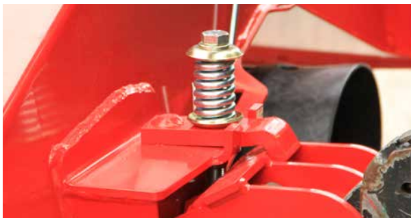
Når der rammes en forhindring, aktiveres NonStop BreakBack-systemet...
